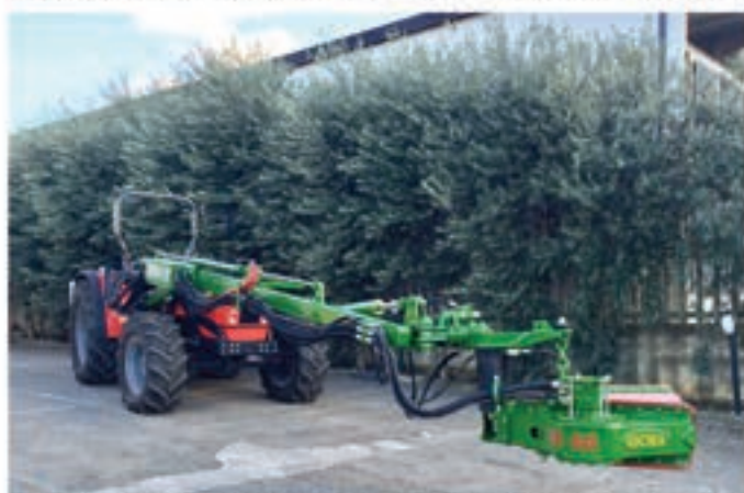
■ ΑΝΑΡΤΩΜΕΝΟΣ ΔΟΝΗΤΗΣ TF 80 (80 HP) ΧΩΡΙΣ ΟΜΠΡΕΛΑ ΜΕΓΙΣΤΟ ΑΝΟΙΓΜΑ ΒΡΑΧΙΟΝΑ 5,5 Μ
