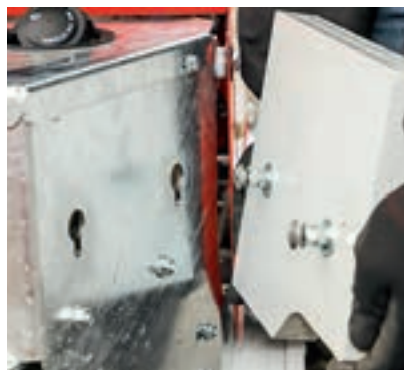
Τα τρία βάρη στο πίσω μέρος μπορούν να τοποθετηθούν χωρίς εργαλεία.
