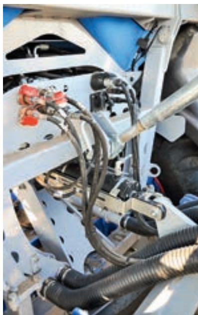
Τριών σημείων σύνδεσμος πίσω από τη χοάνη. Το βάθος μαχαιριών αετάρεται στην άνω ζεύξη.
