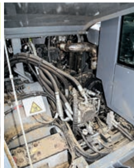
Ο κινητήρας FPT αποδίδει 173 ίππους. Διπλές αντλίες εκτελούν την τροφοδοσία με καύσιμα. Τα δοχεία ψύξης μεταφέρθηκαν πίσω από την καμπίνα, όπου εκτίθενται λιγότερο σε σκόνη, υπολείμματα και φθορά.
