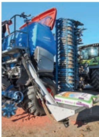
Πολύς σπόρος χύθηκε στο έδαφος όταν το τρυπάνι διπλώνε μέσα και έξω.
