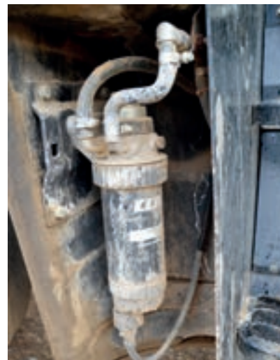
Το φίλτρο καυσίμου του Claas βρίσκεται σε ένα εκτεθειμένο σημείο ανάμεσα στα σκαλιά και το ρεζερβουάρ.
