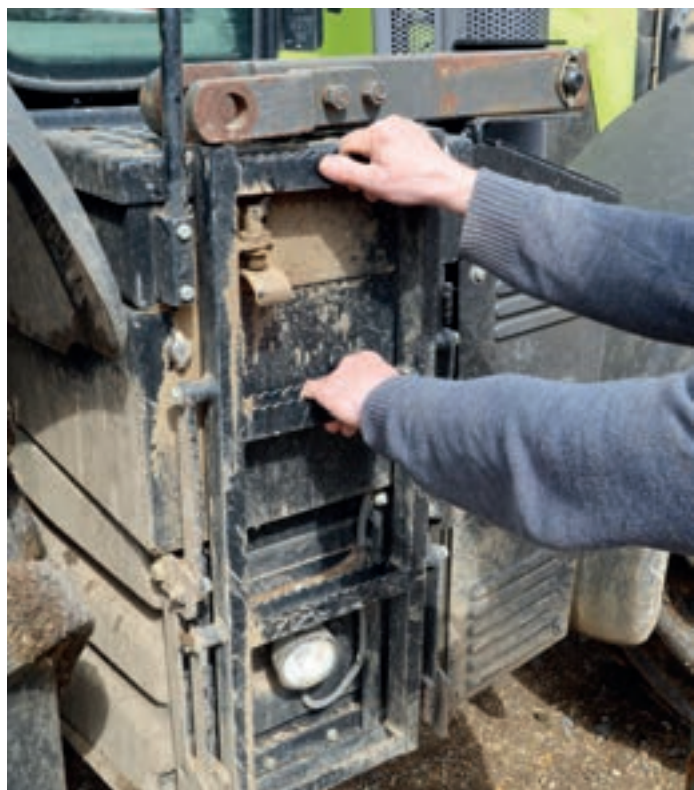
Τα σκαλιά με το πιεσόμενο πάτωμα στη δεξιά πλευρά του τρακτέρ θα πρέπει να δίνουν απευθείας πρόσβαση στο χώρο των μπαταριών.
