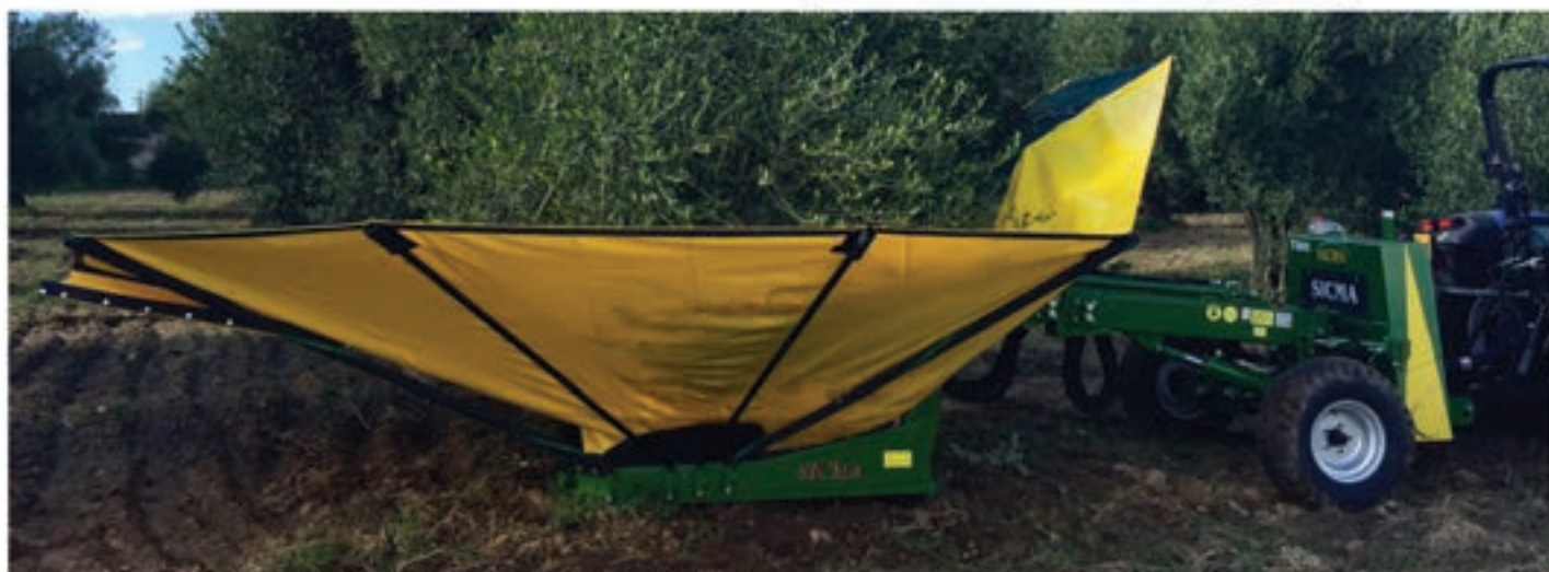
■ ΣΥΡΟΜΕΝΟΣ ΔΟΝΗΤΗΣ TR 80 (80 HP) ΜΕ ΟΜΠΡΕΛΑ ΜΕΓΙΣΤΟ ΑΝΟΙΓΜΑ ΒΡΑΧΙΟΝΑ 6 Μ
