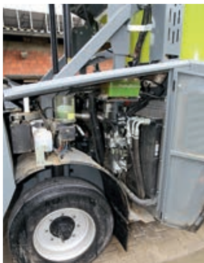
Ο κινητήρας FPT αποδίδει 173 ίππους. Διπλές αντλίες εκτελούν την τροφοδοσία με καύσιμα. Τα δοχεία ψύξης μεταφέρθηκαν πίσω από την καμπίνα, όπου εκτίθενται λιγότερο σε σκόνη, υπολείμματα και φθορά.
