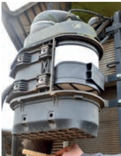
Το φίλτρο αέρα του κινητήρα φράζει συχνά με αποτέλεσμα την απώλεια ισχύος σε δύσκολες καταστάσεις.
