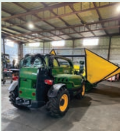
Η απόσταση του σασί του μηχανήματος από το έδαφος είναι στα 27 εκ. κάνοντας εύκολη την οδήγησή του.
