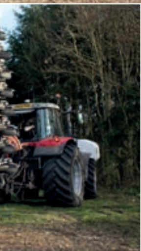
Η εξάμετρο σπαρτική, που διπλώνει στα 2,99 μ., κινείται με πίσω ελαστικά διαστάσεων 710/50 R26.
