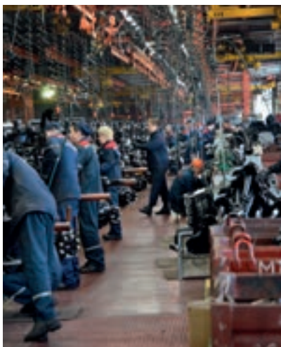
Με μήκος 220 μέτρων η γραμμή παραγωγής που διαθέτει 90 σταθμούς φτιάχνει τρακτέρ 57 έως 122 ίππων.
