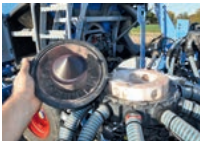
Δεν υπήρξαν παράπονα με την απόδοση της κεφαλής διανομής κατά τη διάρκεια της δοκιμής.
