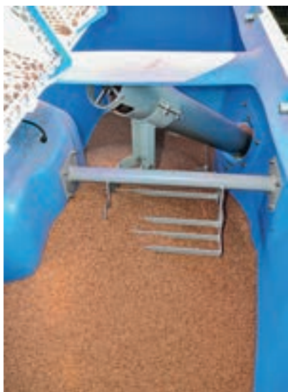
Η πλαστική χοάνη των 3000 λίτρων διαθέτει αποθηκευτικό χώρο για 2400 κιλά σιταριού.
