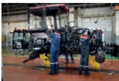
Η δεύτερη γραμμή στο κυρίως κτίριο χρησιμοποιείται για τη συναρμολόγηση εξακύλινδρων τρακτέρ.
