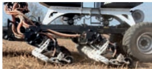
Τα βασικά μέρη του υνιού σπόρων Boss είναι ο παραλληλόγραμμος σύνδεσμος (α), το δισκοειδές υνί υποτομής (β), ο πλευρικός τροχός (γ) και ο τροχός κλεισίματος (δ).
