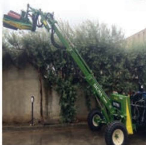
■ ΣΥΡΟΜΕΝΟΣ ΔΟΝΗΤΗΣ TR 80 (80HP) ΧΩΡΙΣ ΟΜΠΡΕΛΑ ΜΕΓΙΣΤΟ ΑΝΟΙΓΜΑ ΒΡΑΧΙΟΝΑ 6 Μ
