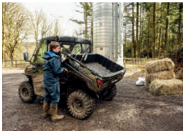
Υδραυλική υποβοήθηση για ανατροπή και μονό μάνδαλο στην πίσω πόρτα.
