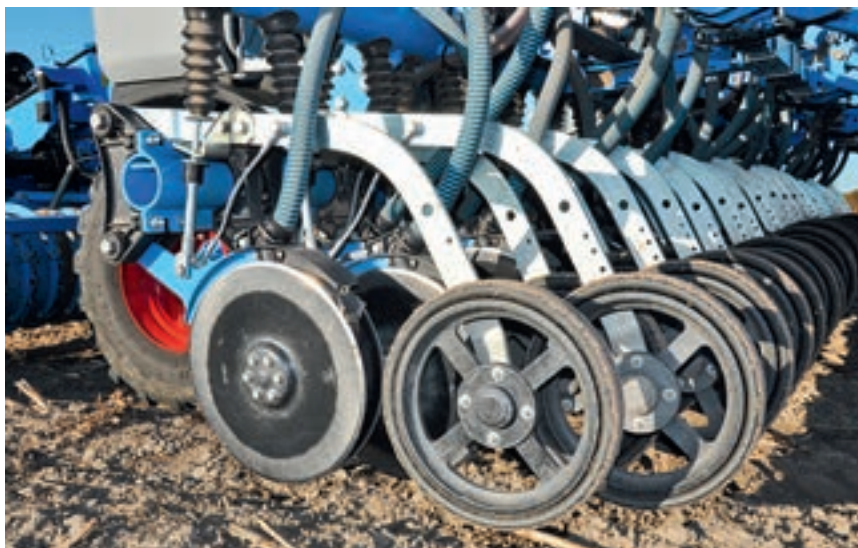
Η απόσταση του μαχαιριού ήταν 150 χιλιοστά με το μηχάνημά μας να έχει υδραυλικό έλεγχο πίεσης. Η τοποθέτηση των κάθε είδους σπόρων ήταν ακριβής.
