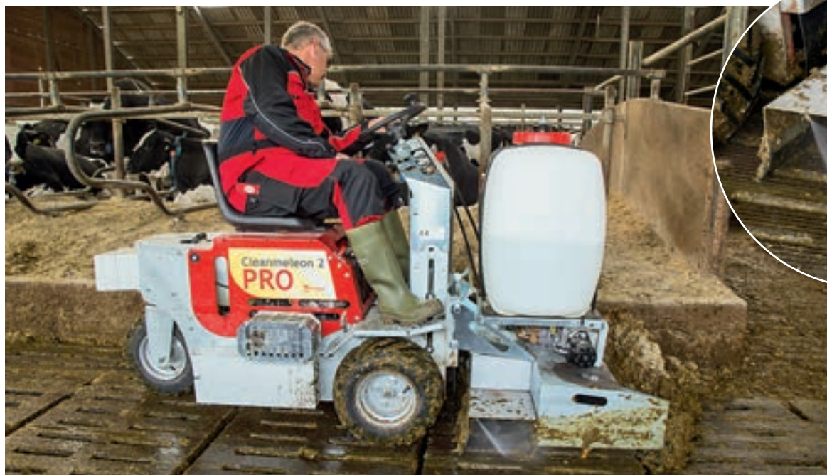
Το CM2 Pro έχει δεξαμενή νερού για να καθαρίζονται τα πατώματα.
