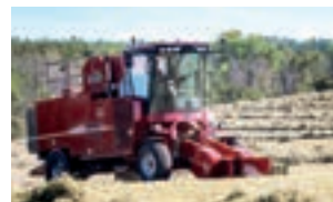
Το μηχανήμα 6240P συλλέγει και δεματιάζει έως 1.200 μπάλες την ώρα.
