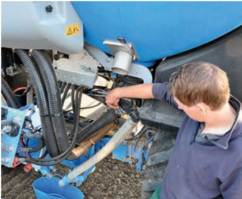
Ο ρυθμός σποράς βαθμονομείται με το άνοιγμα μιας εξόδου σε κάθε μια από τις τέσσερις μονάδες μέτρησης.
