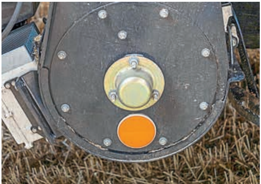
Το μάνταλο που βρίσκεται πάνω από το κέντρο του ανελκυστήρα επιτρέπει την πρόσβαση στον αισθητήρα – για παράδειγμα, για τον καθαρισμό του «ματιού» του αισθητήρα.
