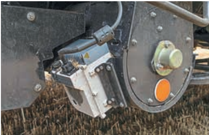
Ο αισθητήρας NIR βρίσκεται στο κάτω μέρος του καλύμματος του ανελκυστήρα της θεριζοαλωνιστικής.
