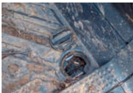
Στις λεπτομέρειες περιλαμβάνονται οι αφαιρούμενες εγκοπές, για να διευκολύνεται η αποστράγγιση του νερού από το δάπεδο της καμπίνας, ενώ αποφεύγεται και η ολίσθηση.
