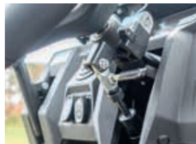
Η ρυθμιζόμενη στήλη του τιμονιού είναι εξοπλισμένη με σύστημα κλειδώματος.
