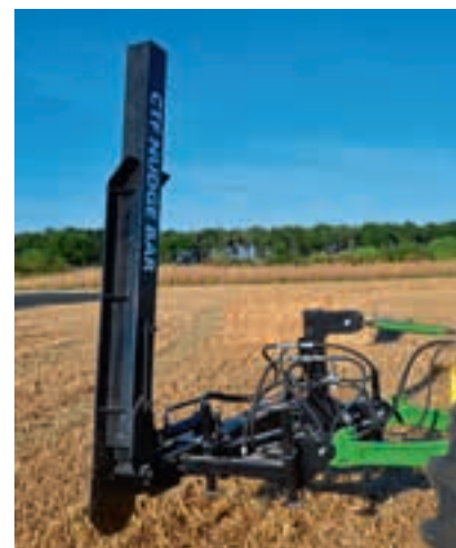
Καθώς οι συσσωρευτές προστατεύουν από την πρόσκρουση σε κάθε επαφή με ένα δεμάτι, η ράβδος ώθησης για την καλλιέργεια ελεγχόμενης κυκλοφορίας βρίσκεται σε γωνία 45° προς την κατεύθυνση της διαδρομής. Στη συνέχεια, διπλώνει κάθετα για την πορεία στον δρόμο.
