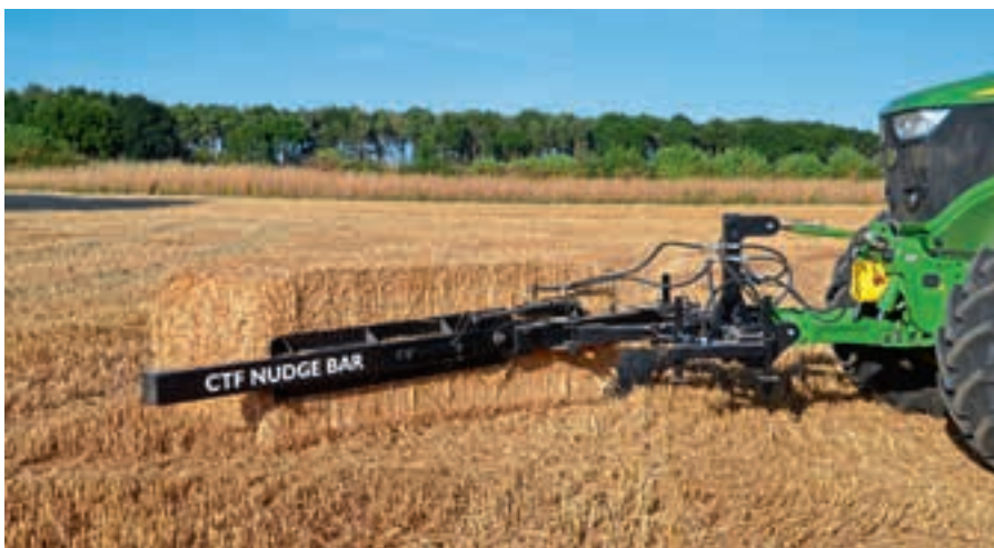
Καθώς οι συσσωρευτές προστατεύουν από την πρόσκρουση σε κάθε επαφή με ένα δεμάτι, η ράβδος ώθησης για την καλλιέργεια ελεγχόμενης κυκλοφορίας βρίσκεται σε γωνία 45° προς την κατεύθυνση της διαδρομής. Στη συνέχεια, διπλώνει κάθετα για την πορεία στον δρόμο.
