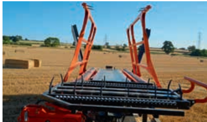
Δύο σειρές από καμπύλα δόντια συγκρατούν τα ζευγάρια των δεματιών επάνω στην περιστρεφόμενη πλατφόρμα προτού περιστραφούν και ανυψωθούν κατακόρυφα. Τα καρφιά στο επάνω μέρος των πλαϊνών θυρών διασφαλίζουν ότι τα δεμάτια συγκρατούνται με όρθια την καρότσα.
