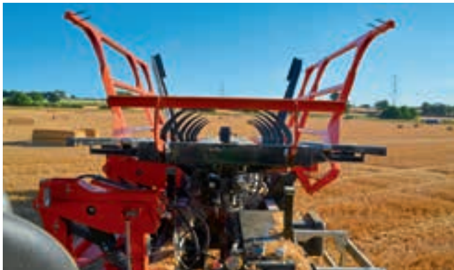
Δύο σειρές από καμπύλα δόντια συγκρατούν τα ζευγάρια των δεματιών επάνω στην περιστρεφόμενη πλατφόρμα προτού περιστραφούν και ανυψωθούν κατακόρυφα. Τα καρφιά στο επάνω μέρος των πλαϊνών θυρών διασφαλίζουν ότι τα δεμάτια συγκρατούνται με όρθια την καρότσα.
