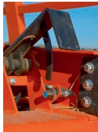
Οι αισθητήρες του Transtacker ανιχνεύουν πότε τα δεμάτια είναι στη θέση τους, ενεργοποιώντας την επόμενη φάση.
