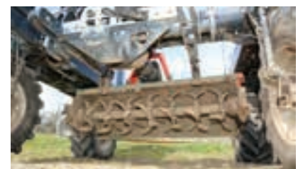
Ο υδραυλικός κινητήρας παρέχει κίνηση στο ρτο και είναι ικανός να αποδίδει 29 ή 54 ίππους 540 ή 1000 σ.α.λ. αντίστοιχα.
