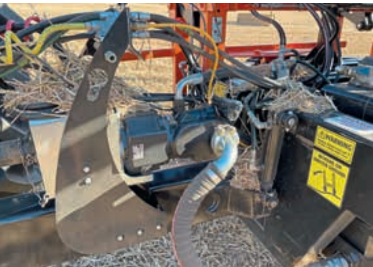
Η υδραυλική αντλία με ροπή της Comer παρέχει το λάδι που απαιτείται για τις λειτουργίες του Transtacker.
