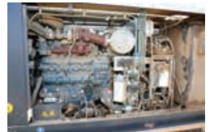
Δύο τετρακύλινδροι πετρελαιοκινητήρες Kubota 2,6 λίτρων και 75 ίππων μεριμνούν για την κίνηση, το ρτο και τα υδραυλικά.
