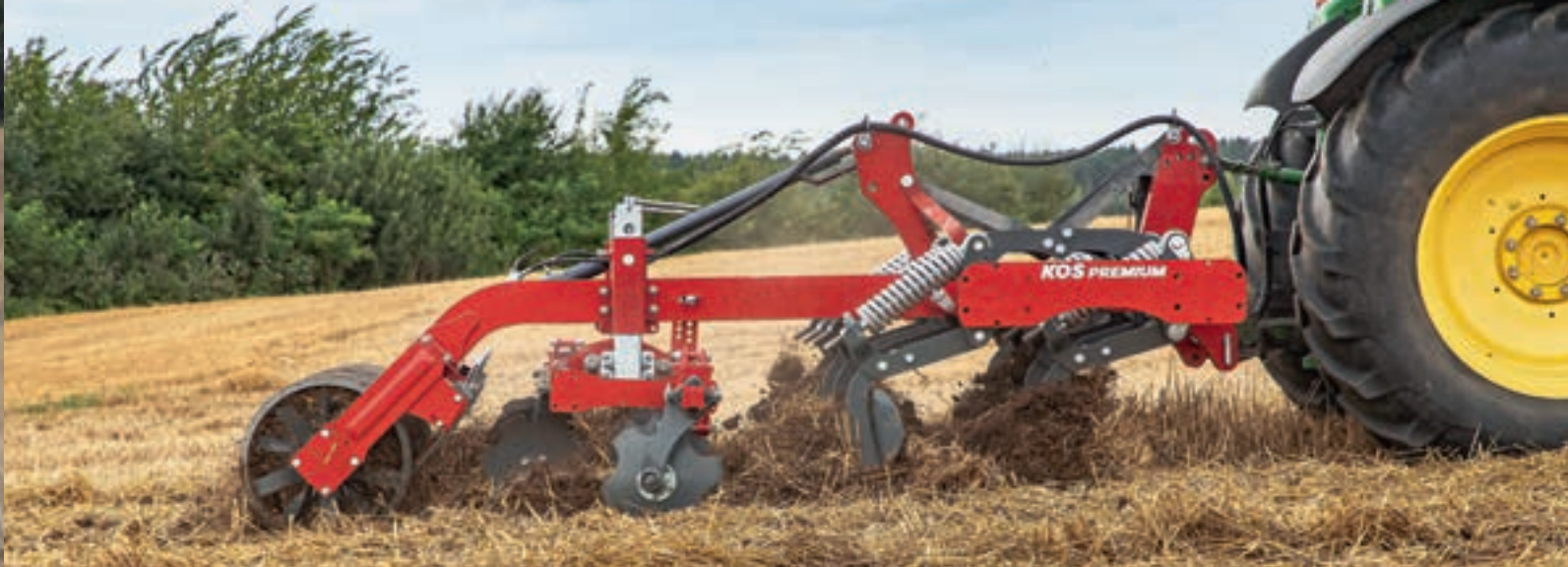
Το Kos Premium έχει οκτώ δόντια σε δύο σειρές που ακολουθούνται από δύο σειρές δίσκων και έναν κύλινδρο. Για τη δοκιμή χρησιμοποιήθηκε τρακτέρ 140 ίππων.
