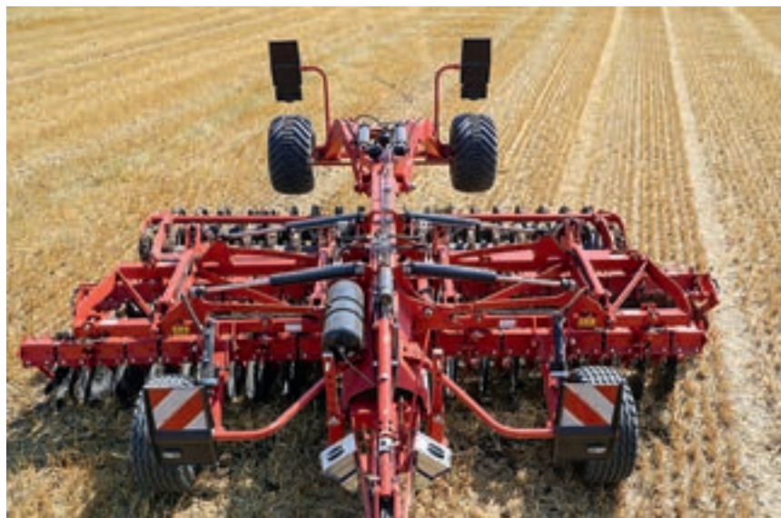
Το ημιαναρτώμενο μηχανήμα αποκτά ένα μακρύτερο και ισχυρότερο πλαίσιο, ώστε να μπορεί τώρα να εξοπλιστεί με έναν κύλινδρο δακτυλίου. Ο κύλινδρος παίζει βασικό ρόλο στη ρύθμιση βάθους του δίσκου.
