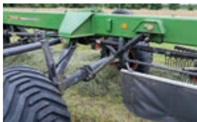
Το υδραυλικό έμβολο ανεβάζει και κατεβάζει το μηχανήμα. Για μεταφορά το Former χαμηλώνει.
