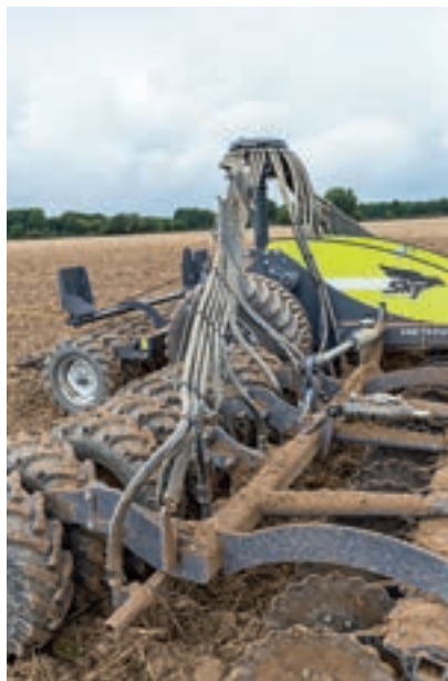
Η εμπρόσθια χοάνη Methys FT1800 προέρχεται από τις σπαρτικές Sulky. Η πρόσβαση διευκολύνει πολύ την πραγματοποίηση της βαθμονόμησης.
