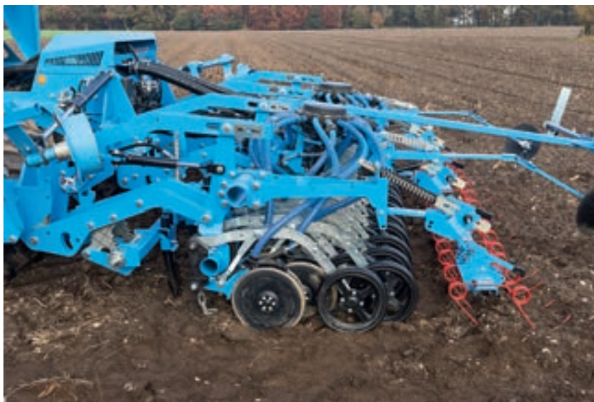
Οι τροχοί μέτρησης αλλάζουν χωρίς εργαλεία για διαφορετικούς τύπους σπόρων.
