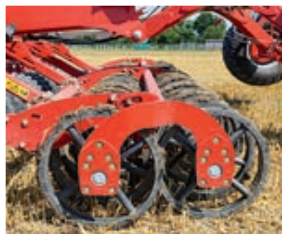
Στο πίσω μέρος του μηχανήματος, οι διπλοί κύλινδροι ActiPress Twin είναι 565 χιλιοστά.
