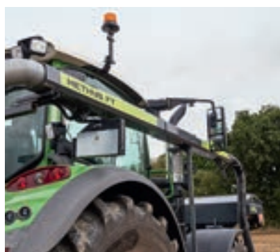
Ο σωλήνας παροχής σπόρων περνά από τον στιβαρό σκελετό και από το πλάι του τρακτέρ της καλλιεργητικής μηχανής.
