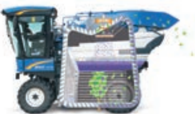
Τα καδάκια Noria επιτρέπουν τη συλλογή και τη μεταφορά χωρίς απώλειες και αλλοιώσεις.
