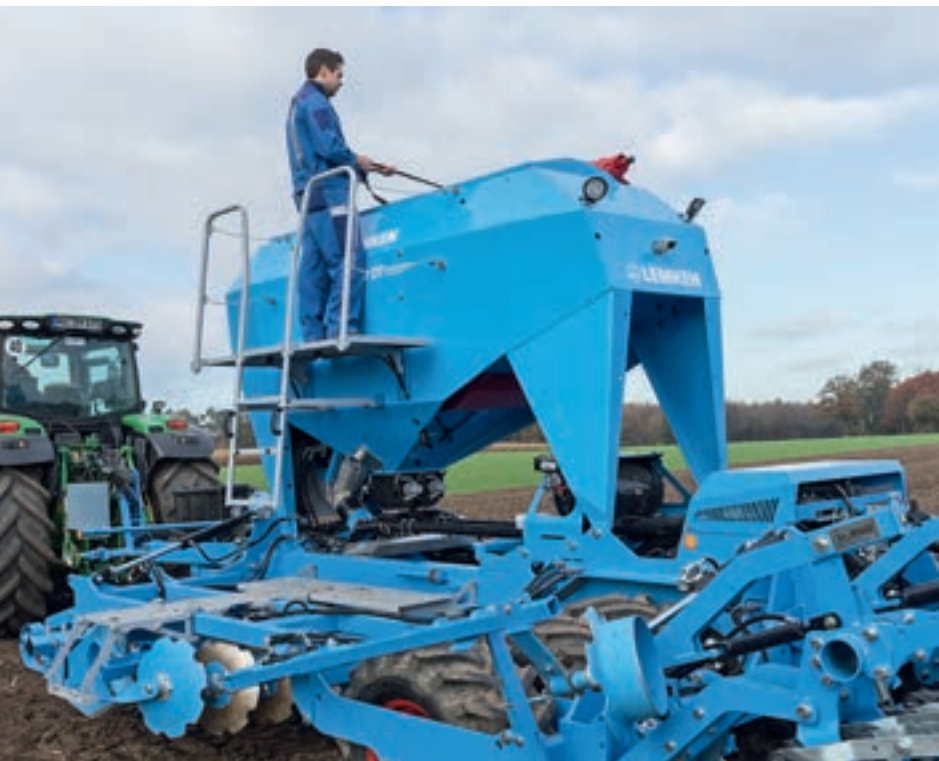
Η κοάνη προσεγγίζεται από το πλάι. Η πλατφόρμα ανεβαίνει αυτόματα μόλις διπλωθεί το παρελκόμενο
