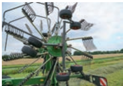
Οι τροχοί σε κάθε ρότορα είναι έξι, όμως η γωνία διεύθυνσης των μπροστινών είναι λίγο «στενή».
