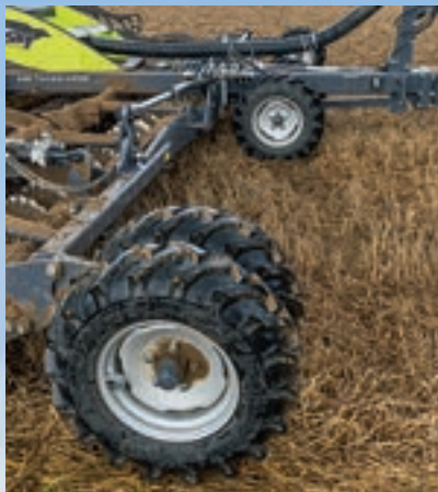
Τρία ζευγάρια τροχών μέτρησης παρέχουν έλεγχο στο μπροστινό μέρος του μηχανήματος.
