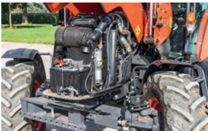
Η μπαταρία, το φίλτρο αέρα και τα ψυγεία για τον τετρακύλινδρο κινητήρα των 3,3 λίτρων είναι όλα πολύ προσβάσιμα.
