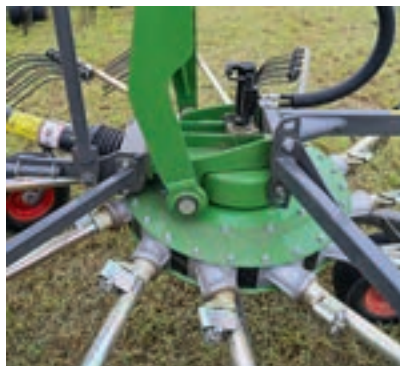
Οι ρότορες σε μια σφαιρική άρθρωση μπορούν να αιωρούνται τόσο εγκάρσια όσο και κατά μήκος προς την κατεύθυνση της διαδρομής.
