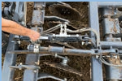
Το βάθος εργασίας ορίζεται από τον χειριστή με διαχωριστικά κλιπ στα πιστόνια των εμβόλων.
