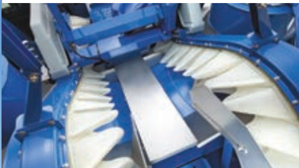
Το σύστημα δόνησης SDC της Braud επιτρέπει σε κάθε ράβδο τινάγματος να είναι ανεξάρτητη.
