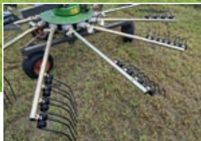
Οι 12 βραχίονες των δοντιών σε κάθε ρότορα αφαιρούνται εύκολα, σε περίπτωση ανάγκης.
