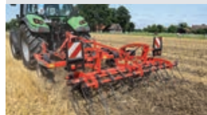
Η νέα σβάρνα εξασφαλίζει πιο ομοιόμορφη κατανομή του άχυρου και των υπολειμμάτων.
