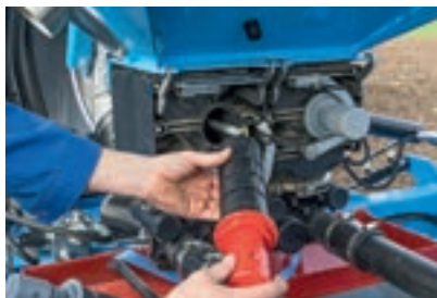
Οι τροχοί μέτρησης αλλάζουν χωρίς εργαλεία για διαφορετικούς τύπους σπόρων.
