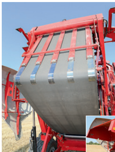
Το σύστημα τυλίγματος με δίκτυ προέρχεται από την Vermeer και βρίσκεται στο πίσω μέρος (φωτογραφία δεξιά).
