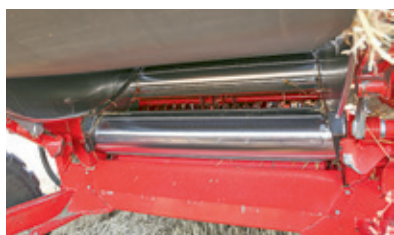
Τα δύο κόκκινα Disc Roller μετακινούνται προς το πίσω μέρος, πίσω από τους δύο κυλίνδρους εισροής και δημιουργούν νέο θάλαμο.
