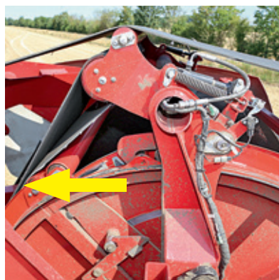
Τα δύο Disc Roller σχηματίζουν ένα ζεύγος (ο ένας κυλίνδρος είναι σταθερός, ενώ ο άλλος κινείται). Το υδραυλικό έμβολο συγκρατεί τη βίδα (βέλος) και περιστρέφει τους δίσκους.
