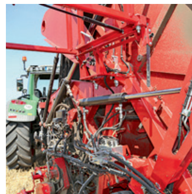
Το οριζόντιο υδραυλικό έμβολο που ανοίγει και κλείνει τον θάλαμο δεματιού ελέγχεται από την κίνηση των τροχών.
