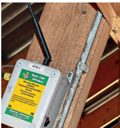
Η θερμοκρασία περιβάλλοντος και/ή υγρασία, είτε μέσα στην αποθήκη είτε έξω από αυτήν, ελέγχεται από μια χωριστή μονάδα και μεταδίδεται ασύρματα στο Gateway.
