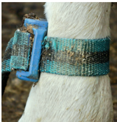
Όλες οι αγελάδες είναι εξοπλισμένες με πομπούς και ποδόμετρα παρακολούθησης.
