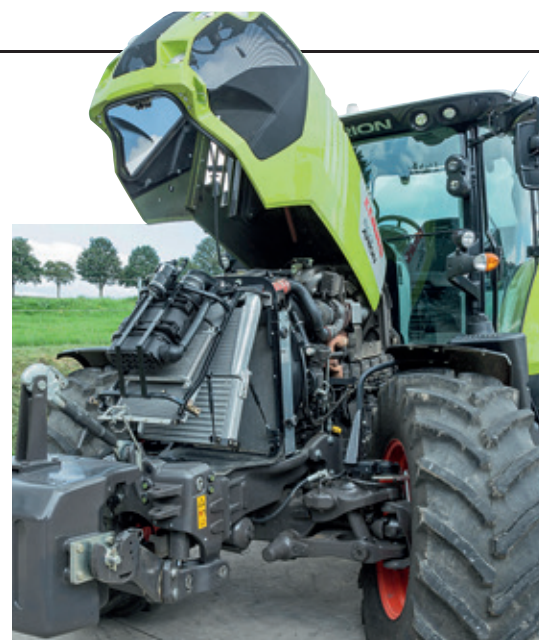
Ο εξακύλινδρος κινητήρας Deere Power Systems είναι συμβατός με Stage IIIB — επομένως, δεν υπάρχει ακόμα AdBlue.
