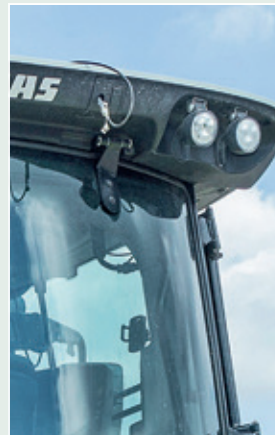
Το καλώδιο της κεραίας του GPS θέλει καλύτερη θέση
