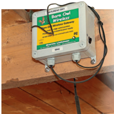
Μια κάρτα SIM κινητού τηλεφώνου και ένα μόντεμ, το οποίο μεταδίδει πληροφορίες σε έναν διακομιστή και στέλνει εντολές στα χειριστήρια
