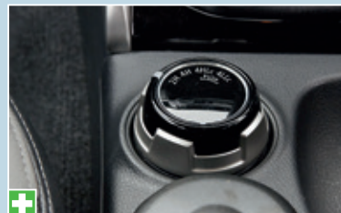
Οι τρόποι οδήγησης επιλέγονται από έναν περιστροφικό διακόπτη.
