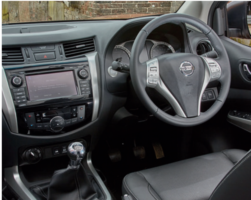
Το ανασχεδιασμένο ταμπλό του Navara είναι όμορφο και εύχρηστο. Το τιμόνι έχει πιο παχύ περίγραμμα σε σύγκριση με το L200, αλλά ρυθμίζεται μόνο η κλίση.
