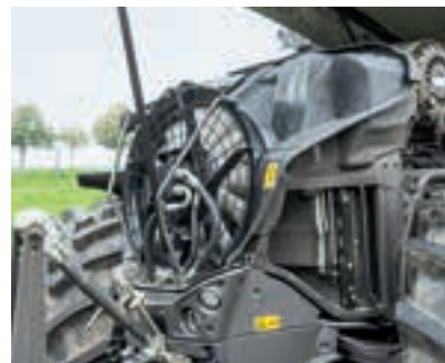
Ο ανεμιστήρας είναι τοποθετημένος μπροστά, ωθώντας τον ψυχρό αέρα μέσα από το ψυγείο. Ο κινητήρας είναι ο «αφανής ήρωας», όντας κρυμμένος αλλά ταυτόχρονα ισχυρός.
