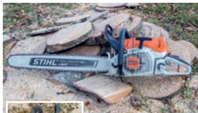
Ερχόμενο στην αγορά ως αντικαταστάτης των MS 441 και MS461, το νέο 72,2 κυβ. εκ. Stihl MS462 των 6 ίππων και των 6 κιλών είναι σαφώς ελαφρύτερο από τον αντικαταστάτη αλλά και επανασχεδιασμένο.
