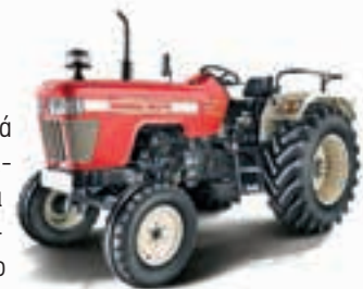
Το Swaraj 963 FE έχει ένα τρικύλινδρο μοτέρ με φυσική αναρρόφηση συνδεδεμένο με μια μετάδοση 12F/2R. Η εταιρεία ιδρύθηκε το 1974 και έχει κατασκευάσει πάνω από 1,3 εκατομμύρια τρακτέρ.
