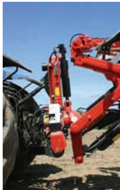
Η ελάχιστη ιπποδύναμη του τρακτέρ για την έλξη του RW 6 που απαιτείται είναι 120 ίπποι.
