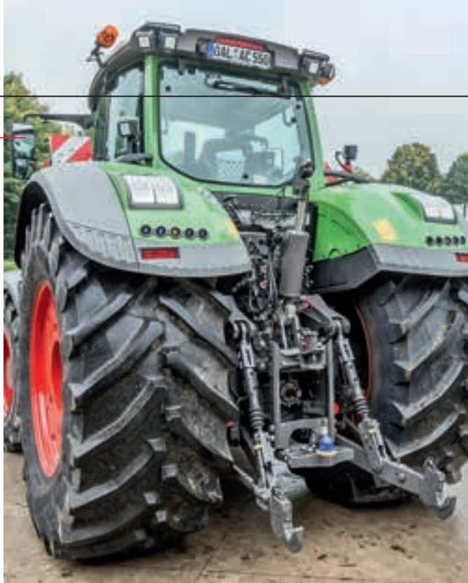
Το συνολικό πλάτος είναι 3 μέτρα ακόμη και με αυτά τα λάστιχα. Μόνιμο χαρακτηριστικό η διαχείριση του συστήματος μετάδοσης από έξω.
