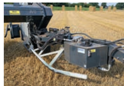
Η δεξαμενή χωράει 80 λίτρα λαδιού. Ψυγείο δεν είναι απαραίτητο. Η ράγα κάνει αποτελεσματική δουλειά για την καθοδήγηση των δεμάτων.
