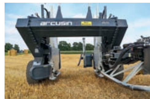
Η ποιότητα κατασκευής είναι κορυφαία. Μπορεί να χειριστεί μπάλες πλάτους 120 και 80 εκ..
