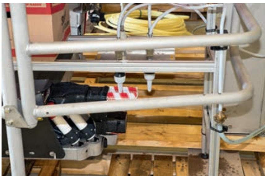
Κάθε άρμεγμα με τον τεχνητό μαστό ξεκίνησε με καθαρισμό και διέγερση των θηλών.
