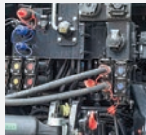
Βαλβίδες: το «+» στο επάνω μέρος αριστερά και κάτω δεξιά.
