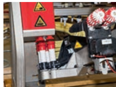
Μετά το άρμεγμα, οι θήκες των θηλών απολυμαίνονται με σπρέι με το Pura System.
