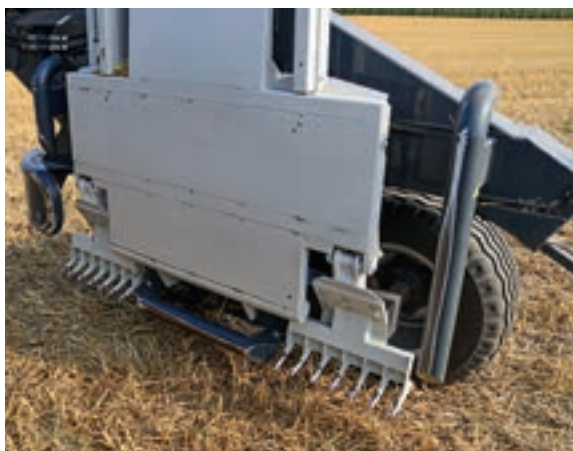
Η λαβή στερεώνει τη μπάλα, η οποία συγκρατείται σταθερά στη θέση της από τις πλευρικές πλάκες.
