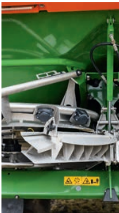
Η πλάκα διανομέα βρίσκεται στο εσωτερικό του αριστερού δίσκου και κινείται υδραυλικά.
