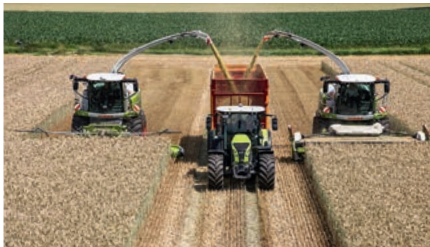
Συγκρίθηκε το Orbis 750 (αριστερά με το Direct Disc 600) στο ίδιο μηχάνημα θερισμού χορτονομής σε όρθια σίκαλη. Το δεύτερο Jaguar ήταν μοντέλο μόνο για τους σκοπούς της φωτογράφισης.
