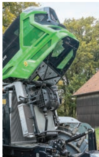
Εξακύλινδρος και με δύο τούρμπο, ο κινητήρας των 6,1 λίτρων «πετάει» καίγοντας λίγα.
