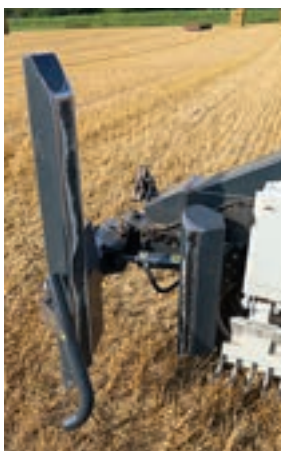
Η λαβή στερεώνει τη μπάλα, η οποία συγκρατείται σταθερά στη θέση της από τις πλευρικές πλάκες.
