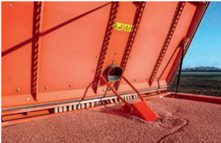
Όταν ανοίξει το καπάκι της χοάνης, ένα προστατευτικό καλύπτει τον πύργο που βρίσκεται μεταξύ του ανεμιστήρα και του διανομέα. Στην φωτογραφία φαίνονται όλα τα εξαρτήματα.
