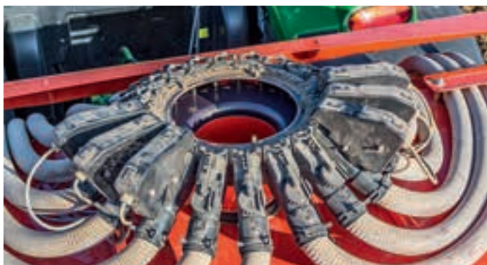
Ως εναλλακτική λύση σε αυτήν την τυπική κεφαλή διανομής, υπάρχει η προαιρετική κεφαλή VistaFlow που προσφέρει πρόσθετες λειτουργίες.
