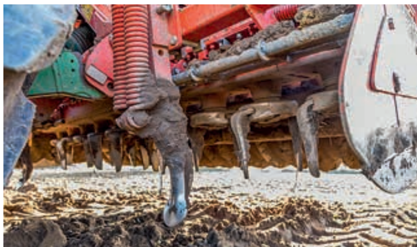
Η Kuhn διατηρεί τους 10 ρότορες στα 3 μέτρα. Τα δόντια γρήγορης εφαρμογής είναι, φυσικά, στάνταρ.
