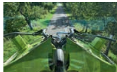
Το κεντρικό τμήμα του προφυλακτήρα τυλίγεται προς τα πάνω και δεν εμποδίζει.
