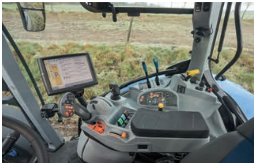
Το υποβραχιόνιο πολλαπλών λειτουργιών είναι σπάνταρντ στο DynamicCommand . Η μεγάλη οθόνη έχει επίσης ένα κόστος.
