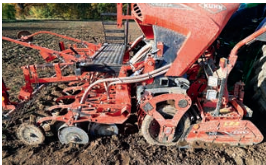
Το Venta βρίσκεται στον κύλινδρο και μπορεί να αφαιρεθεί χωρίς εργαλεία.
