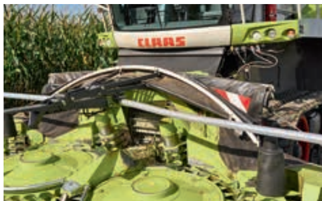
Το κεντρικό τμήμα του προφυλακτήρα τυλίγεται προς τα πάνω και δεν εμποδίζει.
