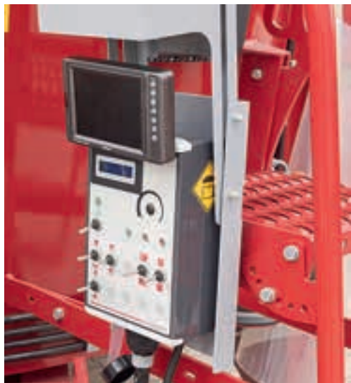
Ο Martin Wille εξακολουθεί να χρησιμοποιεί τη βασική οθόνη BvL (αριστερά), αλλά τα καινούργια μηχανήματα είναι εξοπλισμένα με το προαιρετικό και πιο σύγχρονο ηλεκτρομαγνητικό τηλεχειριστήριο.
