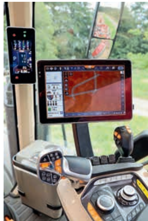
Το AFS Pro 1200 είναι η «καρδιά» του AFS Connect, κυρίως για την αυτόματη καθοδήγηση.
