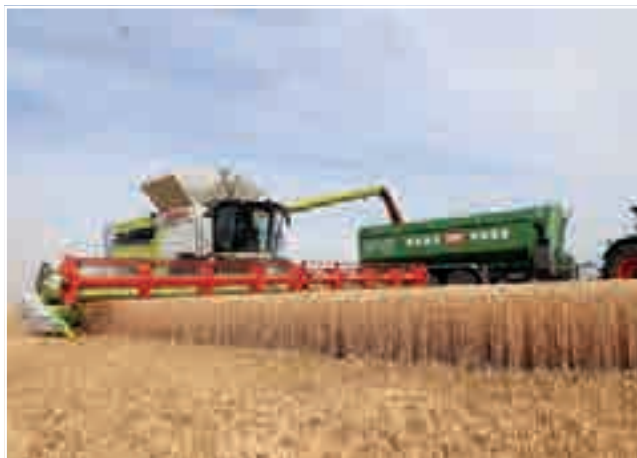
Το 2020 αποτελεί έτος εξέλιξης για τις Claas Lexion που επωφελούνται από τα τύμπανα μεγαλύτερης διαμέτρου στο σύστημα APS για να αυξηθεί η απόδοση. Το 8900 είναι το μεγαλύτερο μοντέλο της Σειράς με επιλογή κάδου 18000 λίτρων.
