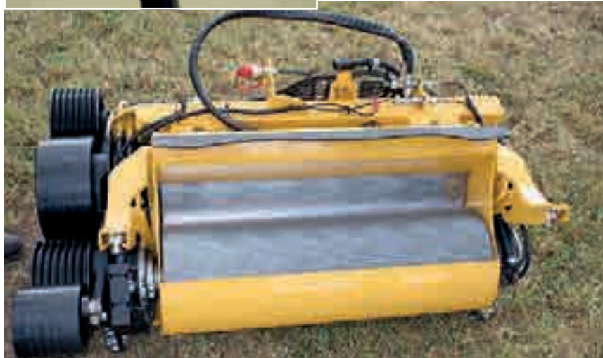
Ο κανονικός επεξεργαστής καλλιέργειας απουσιάζει από το FR920, και αντί αυτού υπάρχει ο βαρύτερος DuraCracker (φωτογραφία) ή ο DuraShredder. Το πρώτο είναι το πιο δημοφιλές, με το DuraShredder να προορίζεται για τους χρήστες που θέλουν ένα μήκος κοπής αραβόσιτου μεγαλύτερο από 25 χιλιοστά.
