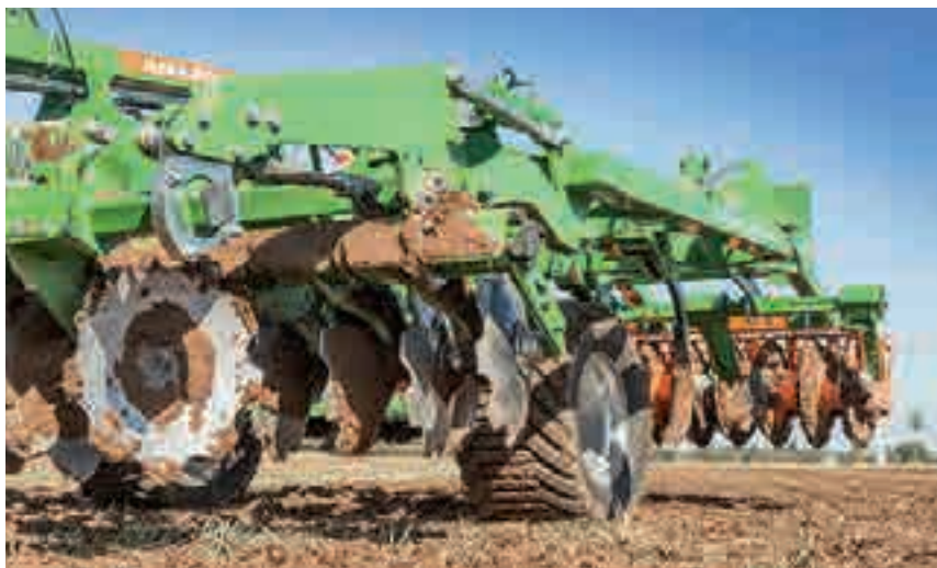
Οι δίσκοι κόβουν και διασκορπίζουν τα υπολείμματα ενώ τα ακόλουθα δόντια ενσωματώνουν το κομμένο υλικό στο έδαφος. Οι ημπαρτώμενοι τροχοί κάνουν το Ceus αρκετά ευέλικτο στο κεφάλι και όχι μόνο.
