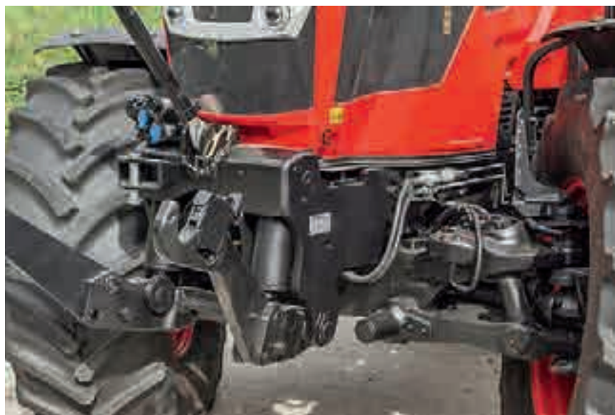
Μηροσπινή ανάρτηση της Carraro στον στάνταρντ εξοπλισμό, εκεί όπου ανήκει και το αυτόματο σύστημα λίπανσης των θηλών, καθώς πολλοί είναι εκείνοι που δεν θέλουν να ασχολούνται καθόλου με αυτό.
