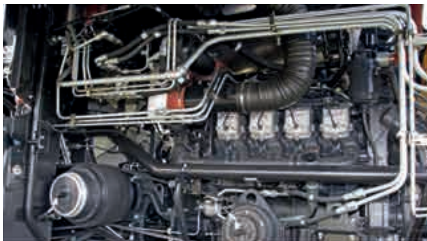
Ο κινητήρας V8 των 20,1 λίτρων της FPT, χρησιμοποιεί το ίδιο μπλοκ όπως στο προηγούμενο μοντέλο Stage II FR850, αλλά έχουν γίνει πολλές αλλαγές σε πολλά εξαρτήματα για να γίνει προδιαγραφών Stage V.
