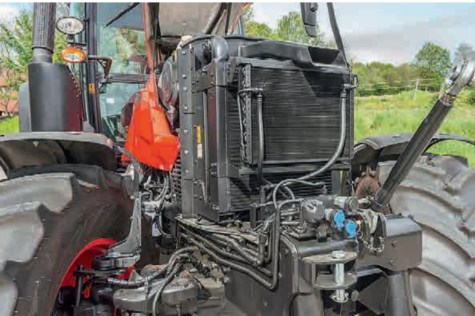
Ο εξακύλινδρος κινητήρας Deutz των 143,5 ίππων (DLG) κρύβεται πίσω από τα εύκολα προσβάσιμα ψυγεία, βέβαια και να μην κρυβόταν δεν θα «χτυπούσε» άσχημα.
