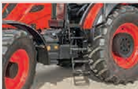
Τα σκαλοπάτια δεν διαθέτουν προστασία από λάσπη. Το ντεπόζιτο πετρελαίου βρίσκεται στην δεξιά πλευρά.
