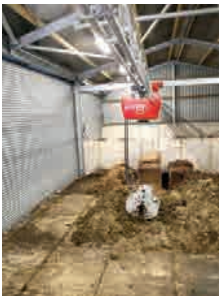
Το σύστημα μεταφοράς της τροφής κινείται κατά μήκος του γερανού, σπκώνοντας το ενσίρωμα και τα σιτηρά.
