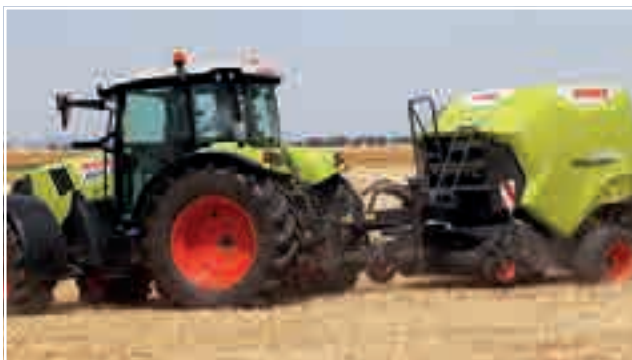
Αντικαθιστώντας τις χορδοειδικές Rollant 340 και 350, οι νέες 520 Rake και RotoFeed διαθέτουν νέο σχεδιασμό στο πάνελ. Οι κύριες αλλαγές εντοπίζονται στο αυτόματο σύστημα λίπανσης της αλυσίδας και στους νέους κυλίνδρους, οι οποίοι είναι παρόμοιοι με εκείνους του μοντέλου 540.
