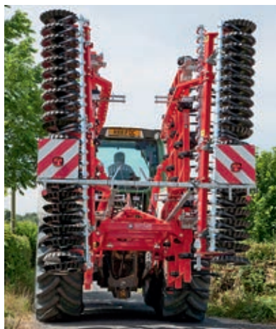
Το πλάτος του SuperMaxx για πορεία στο δρόμο είναι 2,4 μ., φυλάσσεται διπλωμένο.
