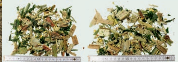
Κοπή 29mm: Στάνταρ θραύστης (αριστερά) και μονάδα Scherer
