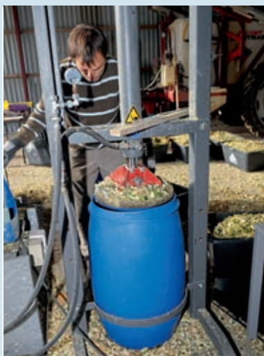
Πρέσα: για να εκτιμηθεί πώς η πυκνότητα συσκευασίας, μήκος κοπής, ξηρή ύλη σχετίζονται στα 500 mm-700 mm κάθε δείγματος.
