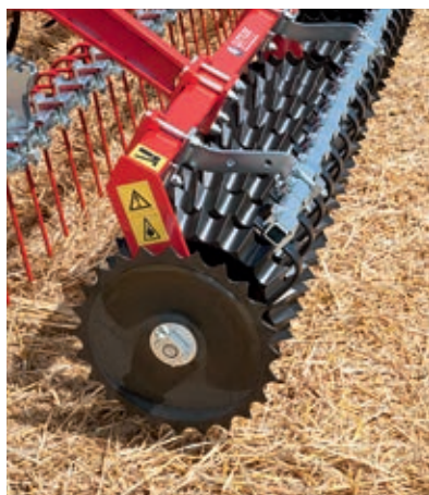
Ο τροχός πίεσης Rollfix έχει δύο διαμέτρους -330 mm και 450 mm- αν και η Wox προτιμά τον μεγαλύτερο.
