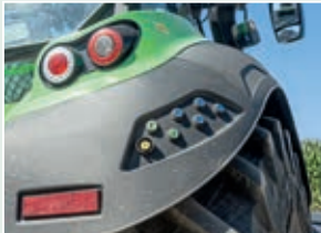
Τα εξωτερικά χειριστήρια ελέγχου βρίσκονται σε ύψος 1,90 μ.
