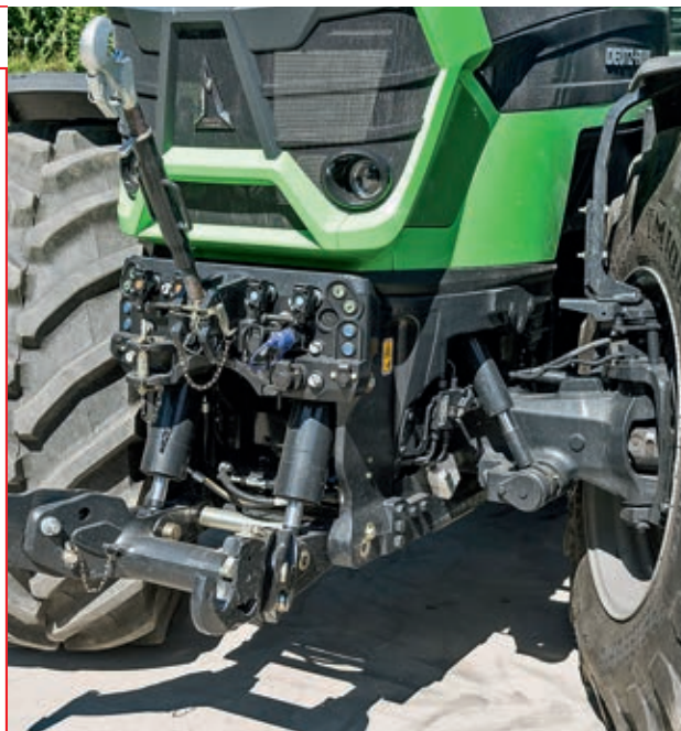
Η μπροστινή ράβδος ζεύξης με στιβαρό υπό-πλαίσιο σηκώνει 4,4 τόνους σε όλα τα επίπεδα ανύψωσης.
