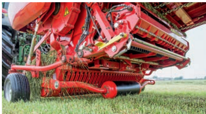
Λεπτά δόντια ρότορα και πλατιές ξύστρες για χαμηλή ισχύ εισροής.
