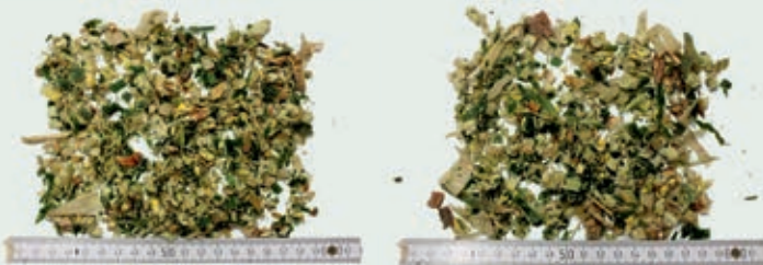
Κοπή 5 mm: Στάνταρ θραύστης (αριστερά) και μονάδα Scherer
