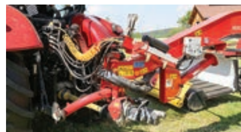
Η μονάδα συνδέεται μέσω ενός κάτω συνδέσμου Cat IIIN. Ο άξονας προ κινεί τρεις αντλίες λαδιού.
