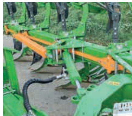
Τρεις ρυθμίσεις αλλάζουν υδραυλικά στο Tyrok 400V: πλάτος μπροστινής αυλακιάς (αριστερά), βάθος (πάνω δεξιά) και πλάτος εργασίας (κάτω δεξιά). Ελάχιστα τα παράπονα.
