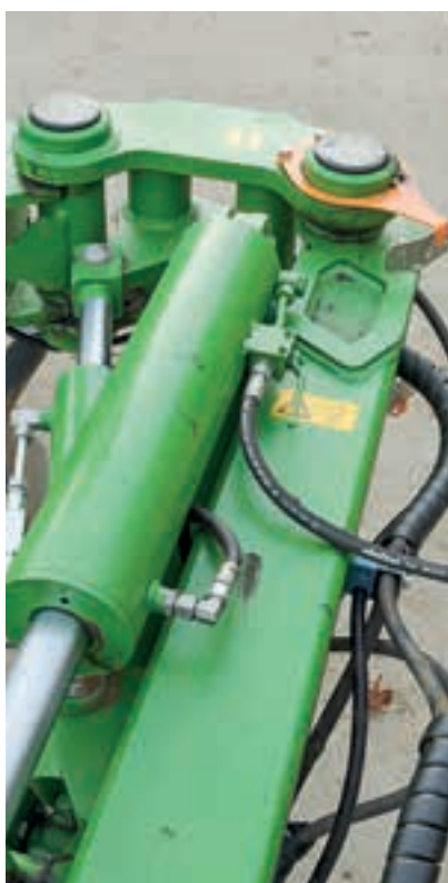
Τρεις ρυθμίσεις αλλάζουν υδραυλικά στο Tyrok 400V: πλάτος μπροστινής αυλακιάς (αριστερά), βάθος (πάνω δεξιά) και πλάτος εργασίας (κάτω δεξιά). Ελάχιστα τα παράπονα.
