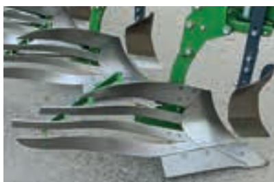
Το σώμα STW35 λειτουργήσε καλά σε μέτρια και βαριά εδάφη σε κάθε συνθήκη.
