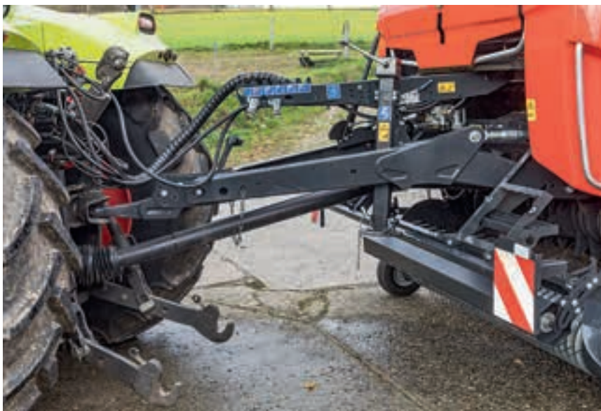
Η ράβδος έλξης (η οποία μπορεί να τοποθετηθεί ψηλά, όπως φαίνεται, για μια σκάλα, ή χαμηλότερα για τον κοτσαδόρο του πικ απ) δεν είναι ακατάστατη. Στις χορτοδετικές παραγωγές θα υπάρχει θήκη σωλήνα.
