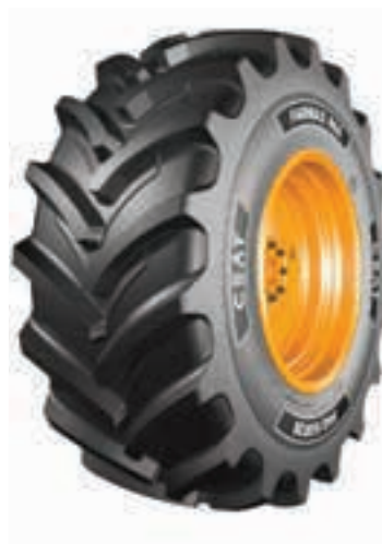
Το πέλμα των ελαστικών αυτής της σειράς, διαθέτει πτερύγια με μεγαλύτερη γωνία κλίσης και μεγαλύτερη αλληλοκάλυψη στο κέντρο.
