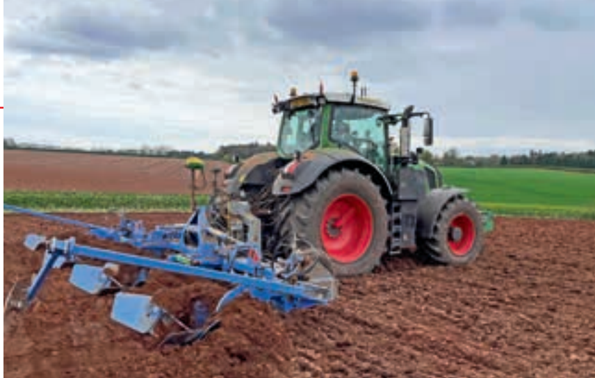
Η πρωτοποριακή κεφαλή βρίσκεται ανάμεσα στο τρακτέρ και στον εκκριζωτή Standen BX και ελέγχεται από έναν δέκτη John Deere Starfire 6000, που χρησιμοποιεί Active Implement Guidance.
