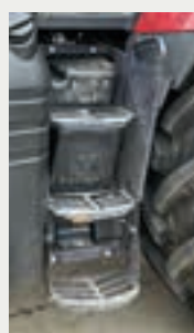
Τα σκαλιά είναι στενά και διαπιστώθηκε ότι το μικρό ενδιάμεσο σκαλί είναι λίγο επικίνδυνο.
