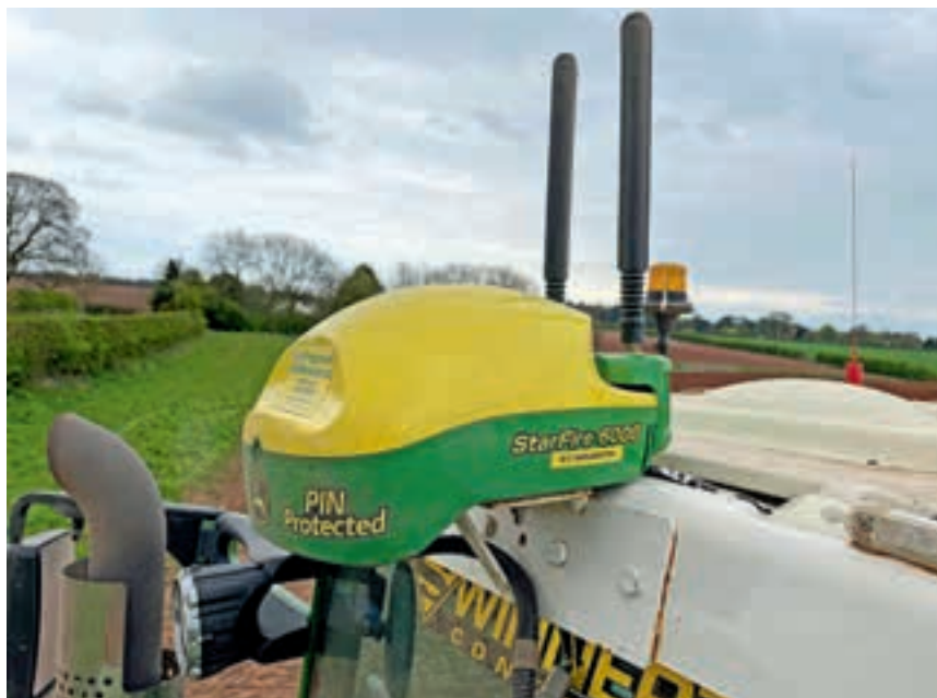
Ο δέκτης Starfire 6000, που συνδέεται στο NTRIP RTK, παρέχει την κύρια καθοδήγηση...
