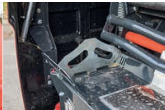
Το δίχτυ κάθετοι σε αυτό το δίσκο και περνά με σπείρωμα από εκεί. Ωραίες οι ρυθμιζόμενες πλευρές για διαφορετικά πλάτη δικτυού.
