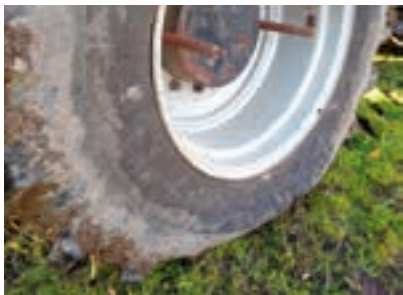
Η χαμηλή πίεση στα Ultraflex αύξησαν την περιοχή επαφής και έδειξαν ιδιαίτερα οφέλη στις αποδόσεις όταν πρόκειται για βαθιά άρωση.
