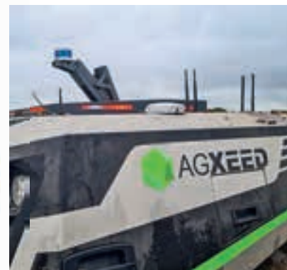
Οι κεραίες GNSS, το ασύρματο δίκτυο και το WiFi επιτρέπουν τον απομακρυσμένο έλεγχο και, φυσικά, την αυτόνομη λειτουργία του AgBot.
