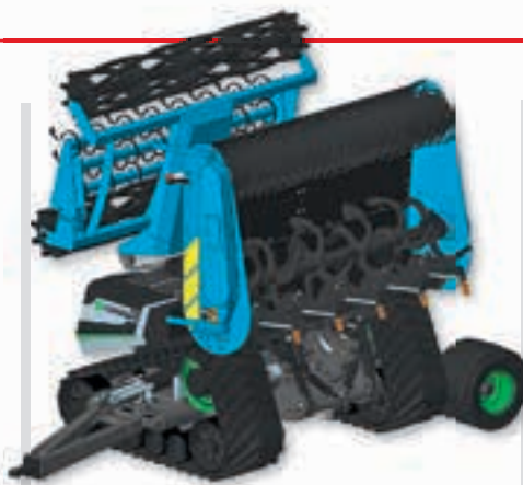
Για μεταφορά σε δημόσιους δρόμους, μια ράβδος έλξης και ένας άξονας μπορούν να συνδεθούν εκατέρωθεν.
