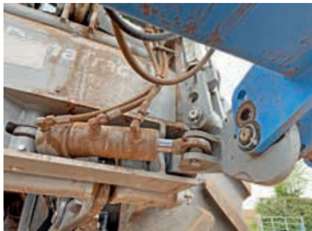
Οι κάτω σύνδεσμοι αιωρούνται, έτσι ώστε να ευθυγραμμίζουν απαλά το εξάρτημα και υπάρχει ένα έμβολο που ασφαλίζει το μηχανήμα για δρόμο.
