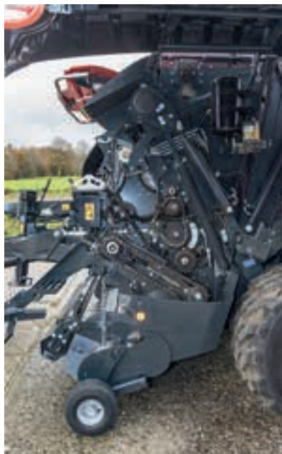
Αριστερά είναι η μετάδοση του πικ απ και η αυτόματη λίπανση, όπως και ο χώρος αποθήκευσης για την πλάκα πλήρωσης ή τις αφαιρεμένες λεπίδες.
