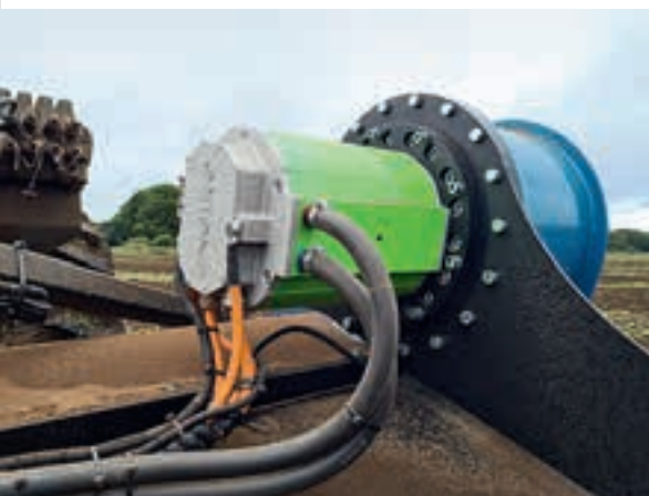
Ο ηλεκτρικός κινητήρας με υγρόψυξη κινεί τον ρότορα του σκαπτικού με συμβατική αλυσίδα.
