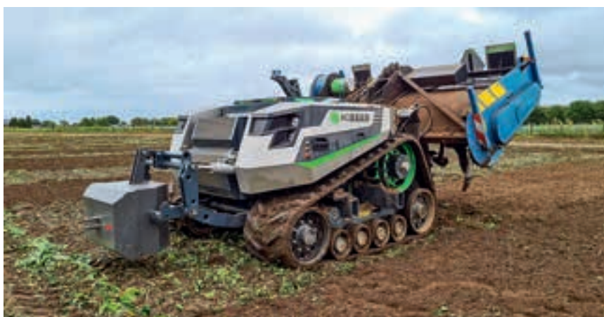
Το πλάτος της τροχιάς μπορεί να ρυθμιστεί από 2,25 μέτρα έως 3,20 μέτρα με τη βοήθεια περνοφόρου.
