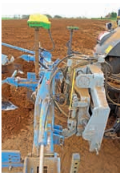
Η σύνδεση της κεφαλής DynaTrac στο υδραυλικό κύκλωμα με αισθητήρα φορτίου επιτρέπει την ταχεία μετατόπισή της όταν απαιτείται.
