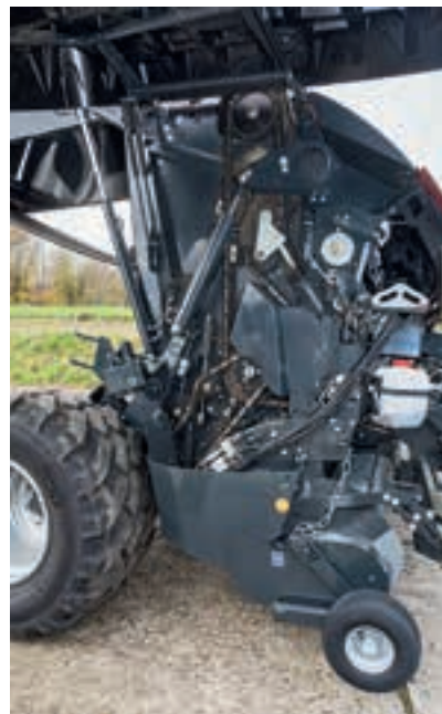
Ο ρότορας και ο κύλινδρος εκκίνησης κινούνται από τη δεξιά πλευρά του μηχανήματος. Η δεξαμενή αποθήκευσης για το λάδι της αλυσίδας είναι εκεί.
