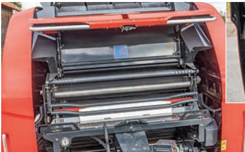
Το δίχτυ κάθετοι σε αυτό το δίσκο και περνά με σπείρωμα από εκεί. Ωραίες οι ρυθμιζόμενες πλευρές για διαφορετικά πλάτη δικτυού.
