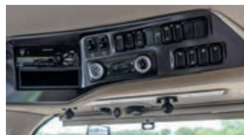
Τα πλήκτρα κλιματισμού και εξαερισμού έχουν μετακινηθεί στην δεξιά πλευρά της οροφής.
