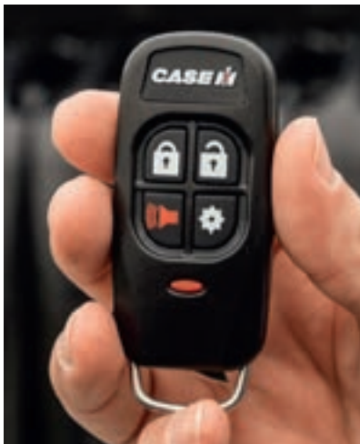
Το κλειδί αποθηκεύει όλες τις σημαντικές ρυθμίσεις στα τερματικά και κλειδώνει ασύρματα την πόρτα.
