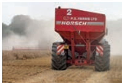
Οι πλατφόρμες Horsch Titan UW 34 φορούν φαρδιά λάστιχα για να περιορίσουν τη συμπίεση του εδάφους.
