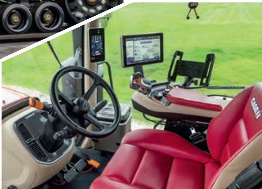
Μεγάλοι χώροι και νέο υποβραχιόνιο που επιτρέπει την περιστροφή του καθίσματος 40 μοίρες προς τα δεξιά.
