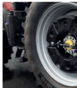
Το Quick-Attach της Pateer επιτρέπει την γρήγορη τοποθέτηση ή αφαίρεση βαριδιών στους τροχούς των τρακτέρ.
