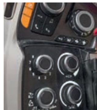
Νέα πλήκτρα στο υποβραχιόνιο για τον έλεγχο συνδέσμου και καρουλιών.
