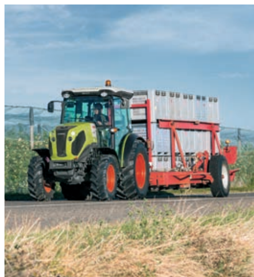
Χάρη στο CPM το Nexos 250 προσφέρει ένα «boost» 9 ίππων κατά τη διάρκεια λειτουργίας του PTO και σε εργασίες μεταφοράς.
