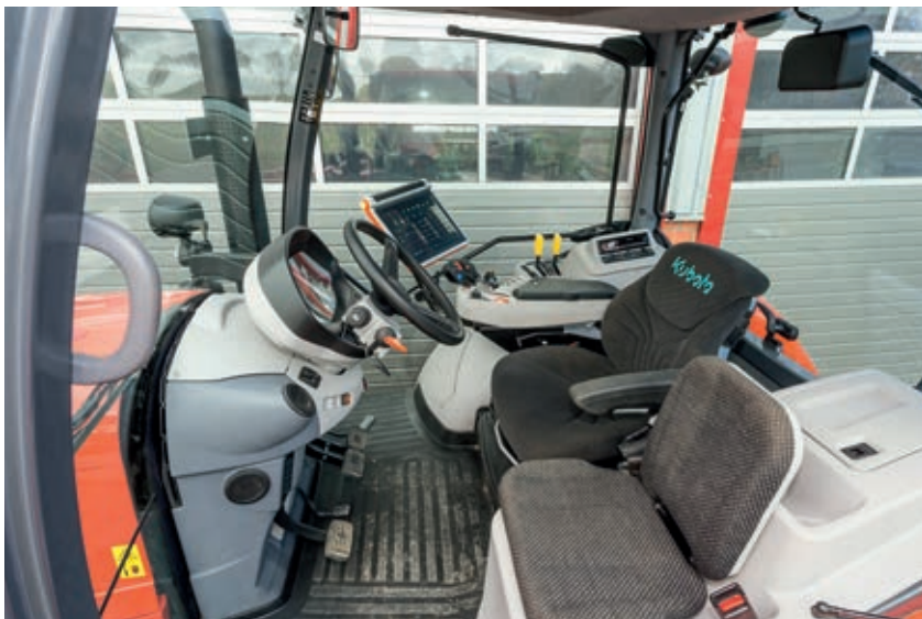
Η καμπίνα με τις τέσσερις κολόνες είναι εντυπωσιακή. Το επίπεδο θορύβου στο εσωτερικό λίγο κάτω από τα 76dB(A) είναι ικανοποιητικό.
