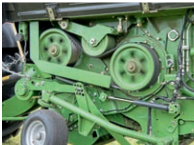
Ένα μέρος της μεγάλης «δίψας» της 430 GD οφείλεται στη συνεχή κίνηση του ιμάντα V με έξι ραβδώσεις από πολυαιθυλένιο.
