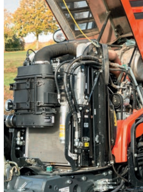
Ο τετρακύλινδρος κινητήρας Kubota 6,1 λίτρων είχε εξαιρετική απόδοση, αλλά θα μπορούσε να είναι πιο οικονομικός στην κατανάλωση καυσίμου.
