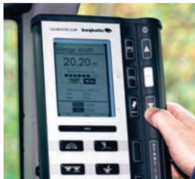
Ο ρυθμός διανομής μπορεί να φτάσει και τα 650 κιλά ανά λεπτό, σε πλάτη 42 μέτρων.
