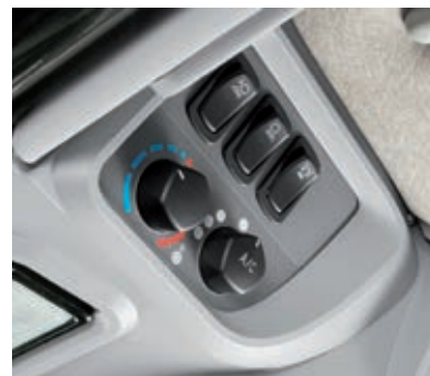
Τα χειριστήρια του κλιματιστικού είναι σε εύκολα προσβάσιμα μέρη στην οροφή.
