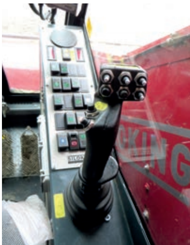
Τα περισσότερα χειριστήρια ελέγχου φόρτωσης και τσίματος βρίσκονται στο τζόιστικ για εύκολο χειρισμό, ενώ οι διακόπτες στο μπράτσο καθίσματος φροντίζουν όλα τα υπόλοιπα.
