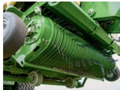
Διατίθεται αυτόματος έλεγχος για την ταχύτητα του συλλεκτικού τυμπάνου. Οι πίσω τροχοί του συλλεκτικού είναι προαιρετικοί.
