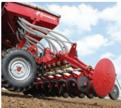
Οι τροχοί είναι εφοδιασμένοι με τυποποιημένα ελαστικά είτε με ελαστικά επιπλεύσεως.
