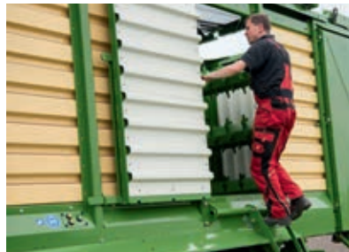
Τα ικανοποιητικά σκαλιά και η φαρδιά πόρτα παρέχουν πρόσβαση στο σώμα, που το δάπεδό του απέχει 1,83 μ. από το έδαφος.
