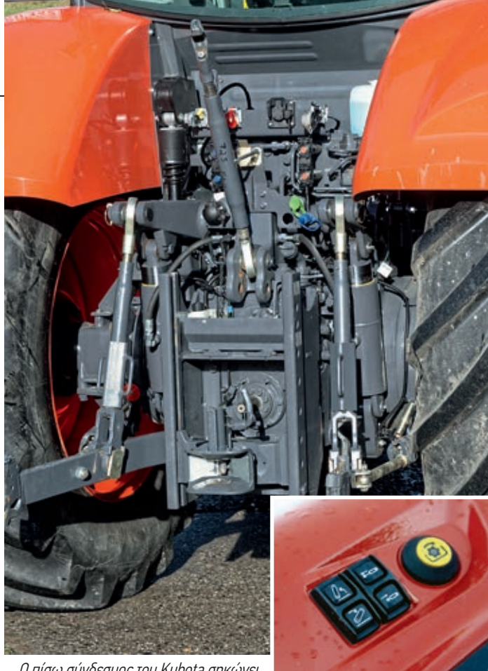
Ο πίσω σύνδεσμος του Kubota σηκώνει πάνω από 6,5 τόνους.
