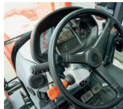
Τα πεντάλ και το ταμπλό είναι σωστά σχεδιασμένα. Η ραβέσσα λειτουργεί από την κολόνα του τιμονιού και το μπράτσο.
