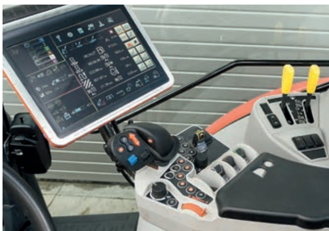
Τα πεντάλ και το ταμπλό είναι σωστά σχεδιασμένα. Η ραβέσσα λειτουργεί από την κολόνα του τιμονιού και το μπράτσο.
