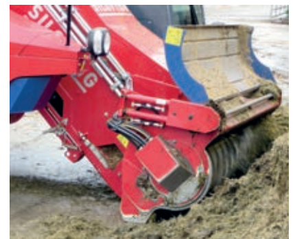
Το περιστροφικό φορείο φρέζας κόβει την πρόσοψη του σιλό για τη συλλογή χορτονομής.
