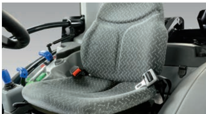
Υπάρχει διαθέσιμη επιλογή μηχανικής ανάρτησης ή προσφέρεται ανάρτηση αέρος ως προαιρετική.
