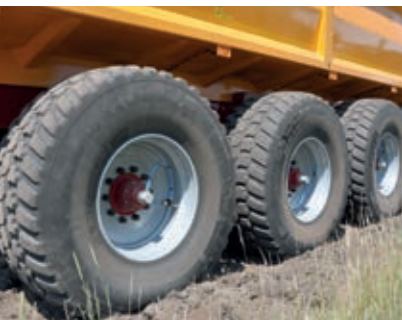
Τα συστήματα CTIS στα ελαστικά ωφελούν μακροπρόθεσμα τη γονιμότητα του εδάφους.
