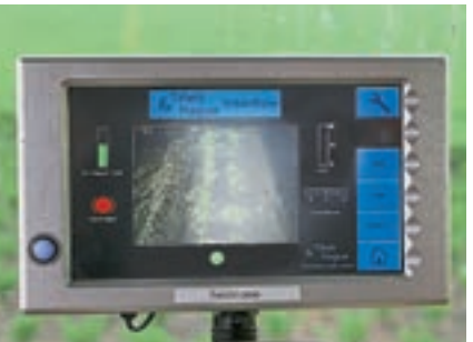
Απλή λειτουργία: Όταν είναι εξοπλισμένο με σύστημα κάμερας και πλαίσιο πλευρικής μετατόπισης, ο χειριστής αρκεί μόνο να ρυθμίσει την ευαισθησία. Η πλευρική καθοδήγηση παρέχεται από ένα παραλληλόγραμμο συρόμενο πλαίσιο.
