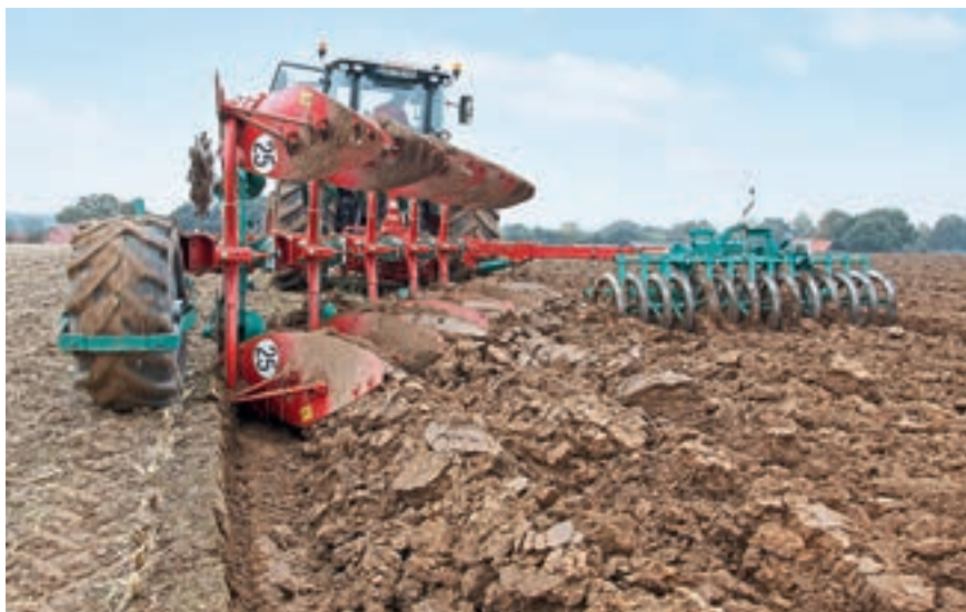
Τα σώματα Νο. 38 καθάρισαν τον πυθμένα του αυλακιού καλά με καλή ποιότητα εργασίας. Όταν ρυθμιστεί σε μέγιστο πλάτος 455 χιλιοστά το υνί, τα σώματα δουλεύουν σε βάθος 300 χιλιοστά.
