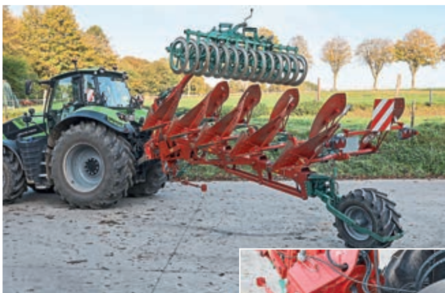
Κατά τη μεταφορά, ο πίσω τροχός βάθους στερεώνεται με το άροτρο να περιστρέφεται στο κεφάλι. Ο συνδυασμός κινούνταν σαν μονότροχο τρέιλερ και προχωρούσε καλά.
