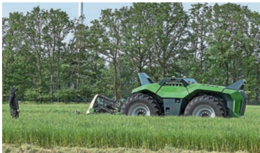
Όταν το VTE εντόπισε αυτό το ομοίωμα, σταμάτησε 15 μέτρα μακριά και ενημέρωσε τον χρήστη του.
