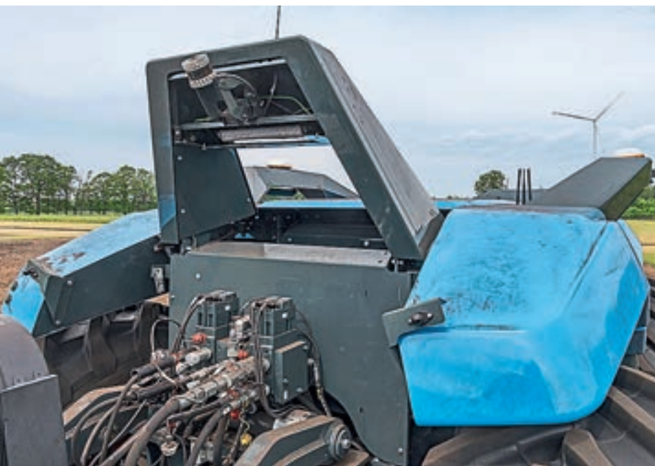
Αισθητήρες και κάμερες παρακολουθούν συνεχώς το περιβάλλον του μηχανήματος.
