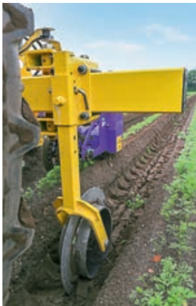
Ο δίσκος διαμέτρου 450 mm εξασφάλιζε την αγκύρωση του κύριου πλαισίου.
