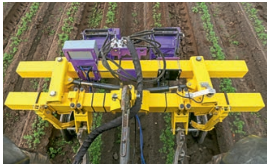
Απλή λειτουργία: Όταν είναι εξοπλισμένο με σύστημα κάμερας και πλαίσιο πλευρικής μετατόπισης, ο χειριστής αρκεί μόνο να ρυθμίσει την ευαισθησία. Η πλευρική καθοδήγηση παρέχεται από ένα παραλληλόγραμμο συρόμενο πλαίσιο.
