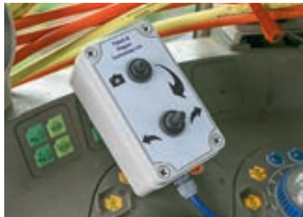
Απλή λειτουργία: Όταν είναι εξοπλισμένο με σύστημα κάμερας και πλαίσιο πλευρικής μετατόπισης, ο χειριστής αρκεί μόνο να ρυθμίσει την ευαισθησία. Η πλευρική καθοδήγηση παρέχεται από ένα παραλληλόγραμμο συρόμενο πλαίσιο.
