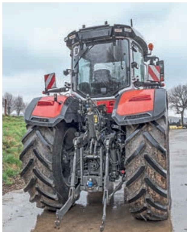
Το 8S έχει υπεραρκετή ανυψωτική ισχύ και υδραυλική απόδοση. Δεν υπάρχουν εξωτερικά χειριστήρια για το πτο στη δεξιά πλευρά.
