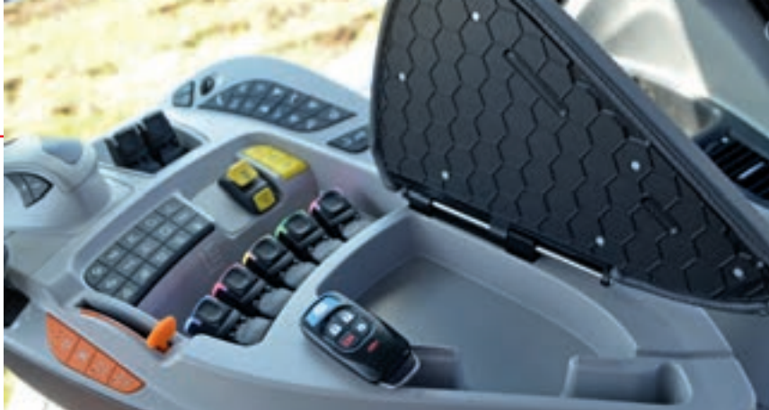
Το σύστημα Keyfob επιτρέπει την είσοδο και την ανάφλεξη χωρίς κλειδί. Υπάρχει επίσης ένα σύστημα ακινητοποίησης -κωδικού PIN- με πρόσβαση μέσω της κύριας οθόνης του υποβραχιονίου.
