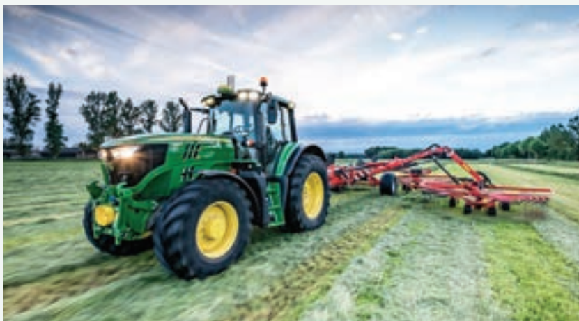
Το 6155M διαθέτει μεταξόνιο 2.765mm. Είναι εξοπλισμένο με κινητήρα 6,8 λίτρων με μέγιστη ισχύς τους 172 ίππους.
