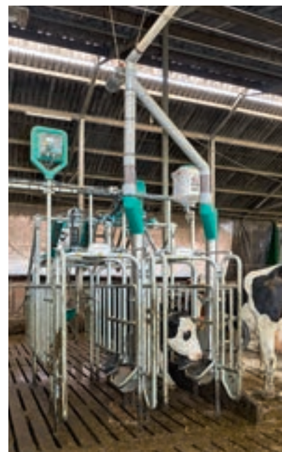
Το Cowtoilet χρησιμοποιεί τις ταϊστρος εκτός πλατφόρμας της Hanskamp με ανοιγόμενη πόρτα.
