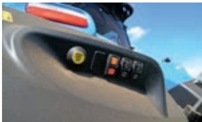
Οι διακόπτες στο λασπωτήρα έχουν ένα κουμπί για εναλλαγή μεταξύ δύο προκαθορισμένων στροφών κινητήρα και του ρελαντί.
