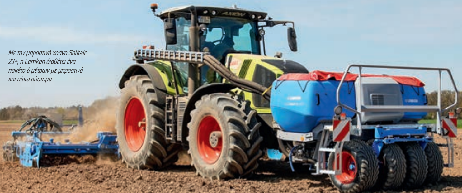
Τα σημεία στερέωσης για το μπροστινό κάδο μπορούν να τοποθετηθούν σε μία από τις δύο θέσεις (+/-20 εκ.) για να ταιριάζουν στο τρακτέρ υποδοχής.
