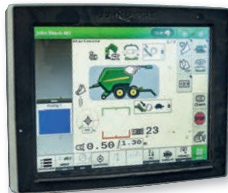
Το C461R είναι συμβατό με ISObus. Η διάταξη είναι λογική, αλλά η λειτουργία δεν είναι πάντα διαισθητική, σύμφωνα με την ομάδα δοκιμής.
