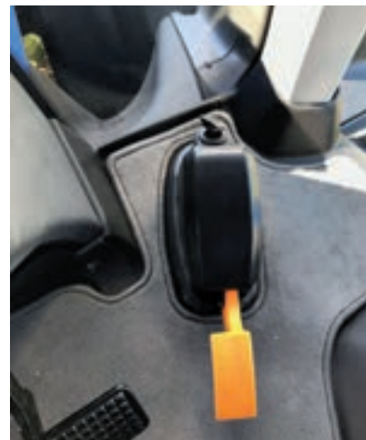
Το αυτόνομο περίβλημα του πεντάλ γκαζιού φιλοξενεί επίσης μια πρίζα 12 volt για ένα ψυγείο στο δεξί χώρο των ποδιών.
