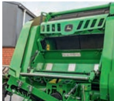
Το στήριγμα του φίλμ ταλαντεύεται προς τα κάτω υδραυλικά, καθιστώντας εύκολο τον χειρισμό.
