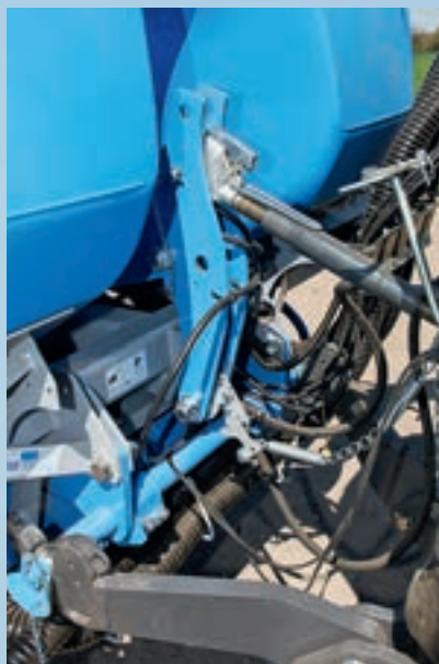
Τα σημεία στερέωσης για το μπροστινό κάδο μπορούν να τοποθετηθούν σε μία από τις δύο θέσεις (+/-20 εκ.) για να ταιριάζουν στο τρακτέρ υποδοχής.
