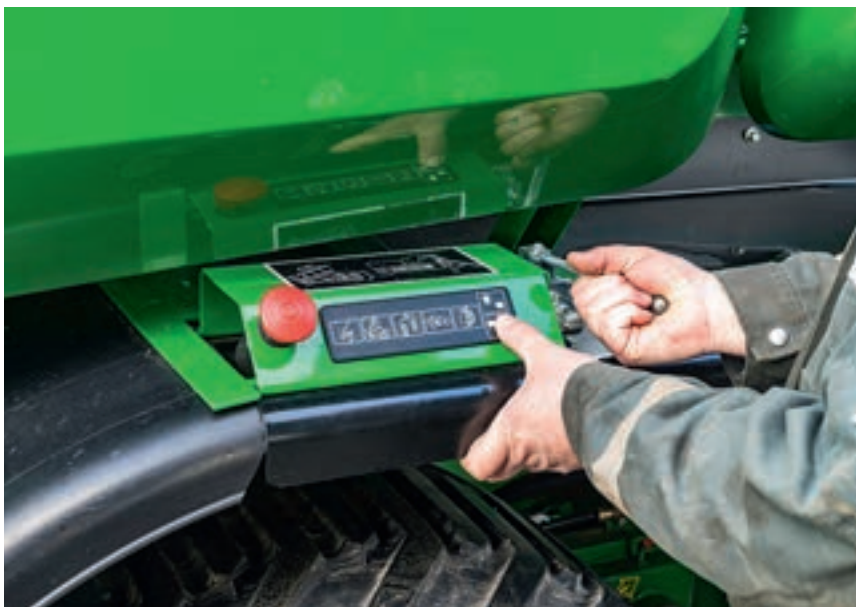
Ο εξωτερικός πίνακας ελέγχου είναι πολύ καλός. Όλες οι βασικές λειτουργίες μπορούν να εκτελεστούν από εκεί.
