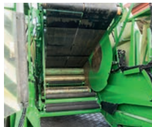
Ο θάλαμος χορτοδεσίας έχει δύο φαρδιούς ιμάντες και τρεις κυλίνδρους. Τα πλαίσια πάνελ σχηματίζουν τους τοίχους και η πόρτα αντικαθίσταται από μια κουρτίνα, αυτόνομο μεταβλητό χορτοδετικό 990.
