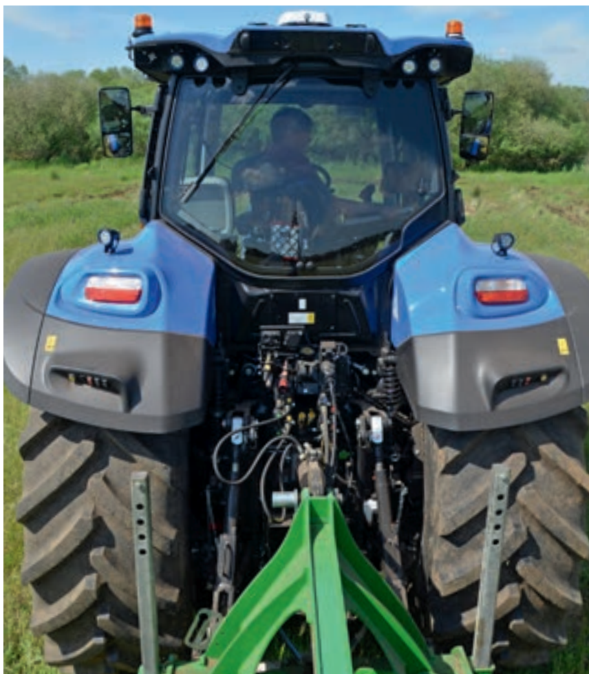
Το πίσω παράθυρο είναι πιο μέγα από πριν και προαιρετικά όλα τα τζάμια δέχονται ειδική υδροφοβική επίστρωση αυτοκαθαρισμού. Το ελατήριο και η ανάρτηση εξακολουθούν να είναι στον βασικό εξοπλισμό του μοντέλου.
