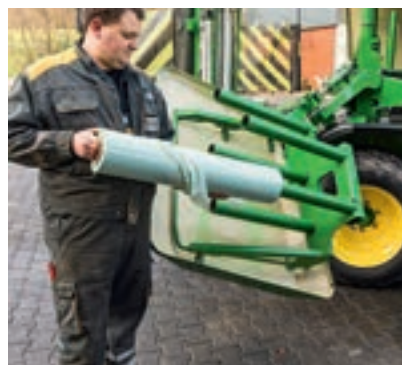
Το στήριγμα του φίλμ ταλαντεύεται προς τα κάτω υδραυλικά, καθιστώντας εύκολο τον χειρισμό.
