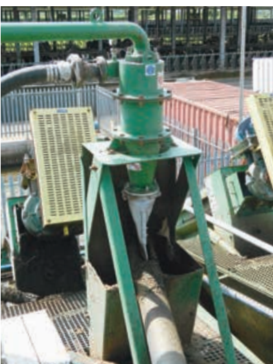
Ένας μηχανισμός βοηθάει στην αφαίρεση της πολύ λεπτής άμμου.
