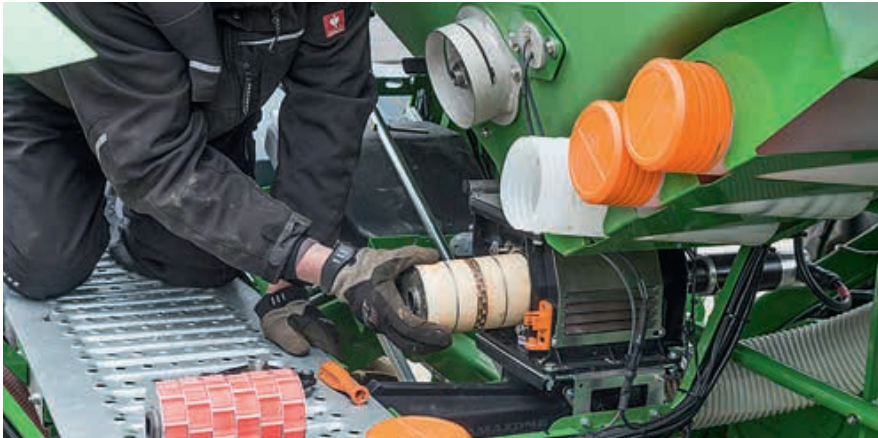
Οι μονάδες μέτρησης αποθηκεύονται σε πλαστικούς σωλήνες με κάλυμμα και αντικαθίστανται πολύ γρήγορα (αριστερή εικόνα).
