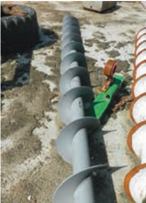
Το μέγεθος του αναδευτήρα για τη μεταφορά της κοπριάς στη σχάρα υποδοχής.
