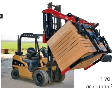
Στο KK3500 αντί να τοποθετεί το κιβώτιο πλάγιως, το τοποθετεί από μπροστά.
