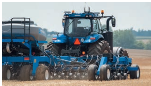
Το NH Drive αποτελεί ένα πλήρως αυτόνομο όχημα, δηλαδή δεν χρειάζεται οδηγό μέσα στην καμπίνα, και είναι βασισμένο στο μοντέλο T8 Blue Power.
