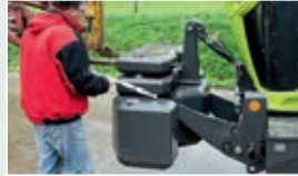
Έρμα για το ρύγχος: Κατώτερο βάρος 1.800 με σφήνες 400 κιλά
