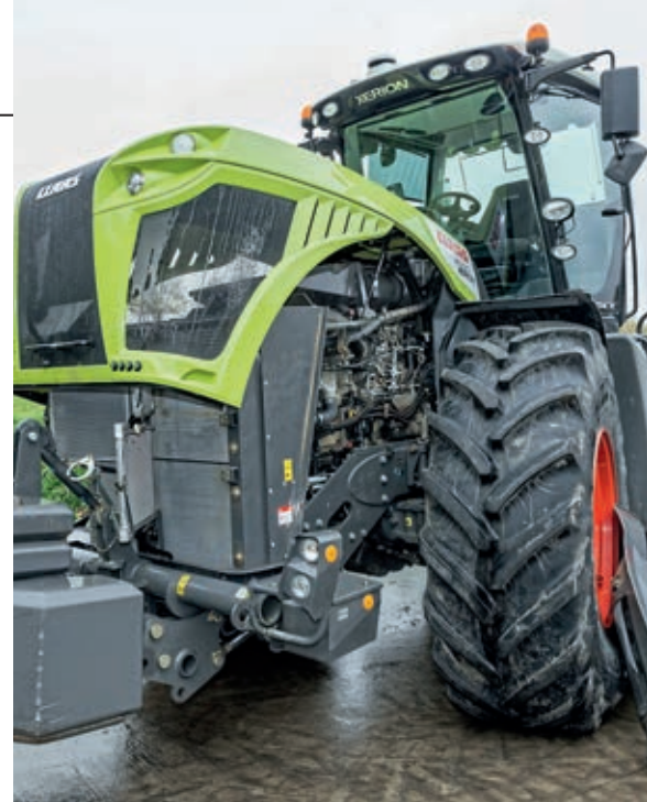
Κάτω από το τεράστιο κιτρινοπράσινο καπό βρίσκειται ένας κινητήρας Mercedes 10,6 λίτρων.
