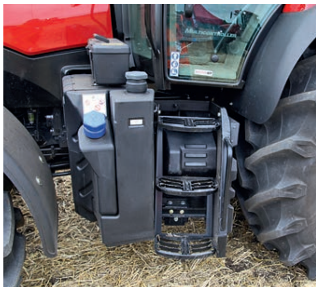
Το ντεπόζιτο καυσίμου χωρά 250 λίτρα καυσίμου και 39,5 λίτρα AdBlue. Για να χωρέσουν μεγαλύτερα ντεπόζιτα τα σκαλιά έπρεπε να μικρύνουν.
