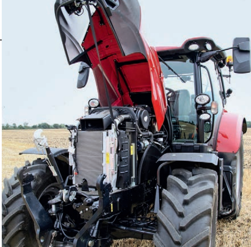
Η ισχύς προέρχεται από έναν κινητήρα FPT 4,5 λίτρων με τέσσερις κυλίνδρους. Το μοντέλο-ναυαρχίδα θα αντλεί ισχύ από έναν κινητήρα 6,7 λίτρων με έξι κυλίνδρους και 175 ίππους.
