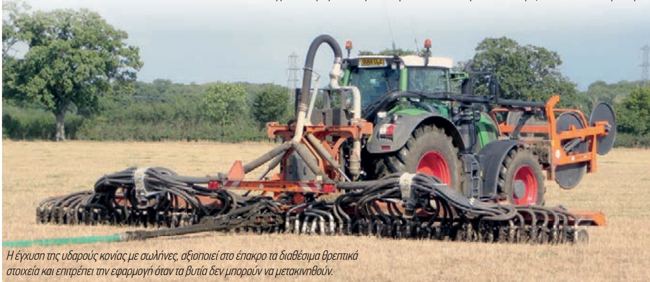
Ο Gareth Powell χρησιμοποιεί ειδικό εξοπλισμό άντλησης που περιλαμβάνει αναδευτήρα Pit Pal που ενσωματώνει μια αντλία χαμηλής πίεσης.
