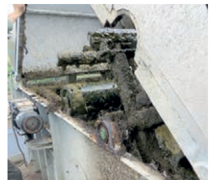
Περιστρεφόμενοι χτυπητήρες διαχωρίζουν τα υγρά από τα στερεά υλικά.
