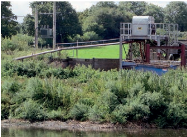
Ο διαχωριστής με σήτα NC επεξεργάζεται την υδαρή κοπριά και τη μετατρέπει σε στερεά υλικά και το υγρό αδειάζεται με αντλία.
