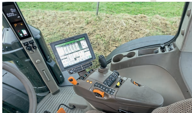
Η ηλεκτροϋδραυλική ραβέρσα έχει ασφάλεια στάθμευσης. Το προαιρετικό τιμόνι έχει ωραία αίσθηση.
