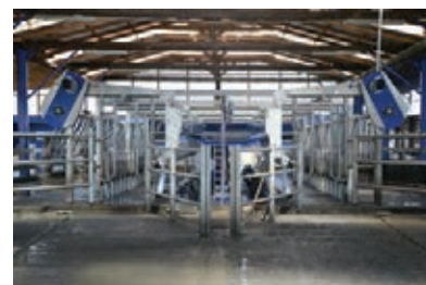
Το SBS 2x25R έχει εγκλωβισμό κατασκευασμένο εξολοκλήρου από ανοξείδωτο χάλυβα.
