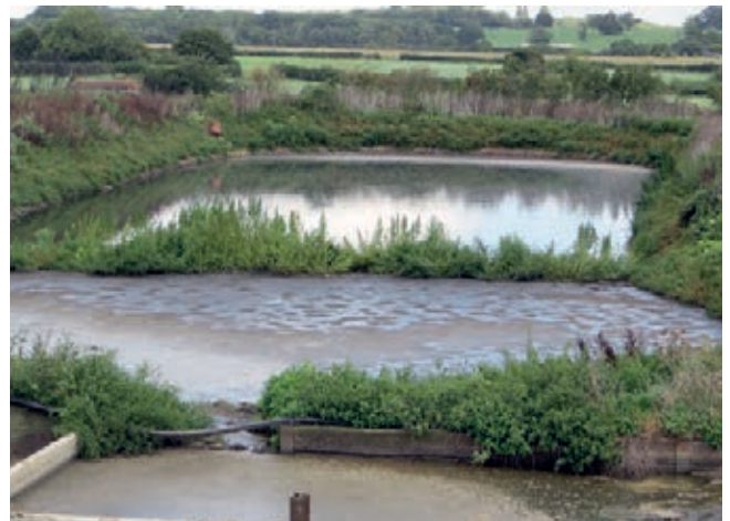
Η υδαρής κοπριά πέφτει στη λωρίδα άμμου όπου η άμμος κατακάθεται προτού το διαχωρισμένο υγρό χωρίς άμμο αντλείται στην τάφρο.
