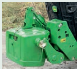
Ο επάνω σύνδεσμος πρέπει να ρυθμίζεται με μεγάλη ακρίβεια.
