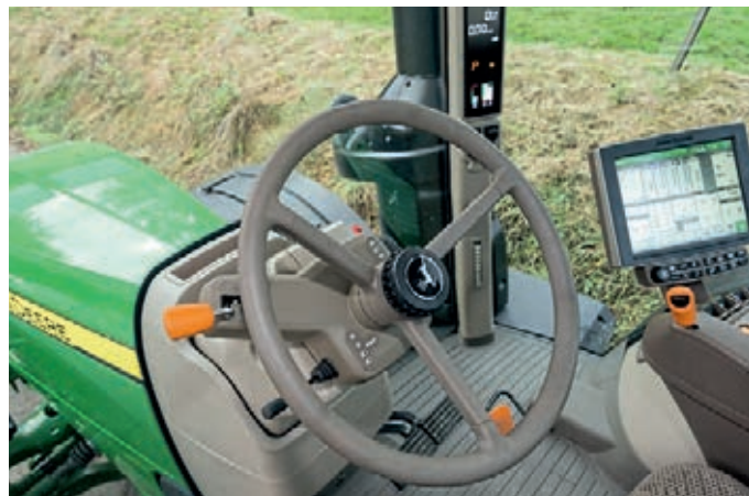
Η ηλεκτροϋδραυλική ραβέρσα έχει ασφάλεια στάθμευσης. Το προαιρετικό τιμόνι έχει ωραία αίσθηση.
