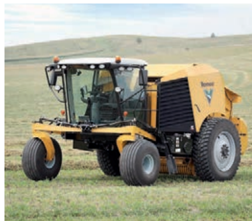
Το πρωτότυπο Vermeer ZR5 έχει κινητήρα 173 ίππων Cummins και καμπίνα από την Claas.
