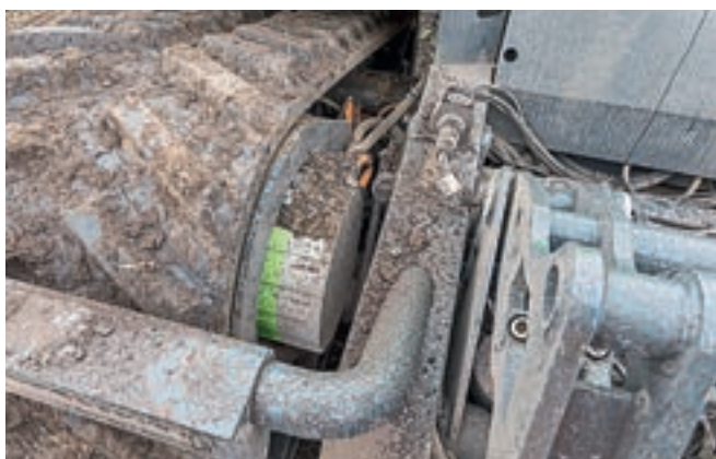
Τα ηλεκτρικά μοτέρ κινούν τις ερπύστριες με ταχύτητα πορείας από 0,1 έως 13 x.a.ώ. Το μηχάνημα ζυγίζει περίπου 7 τόνους.
