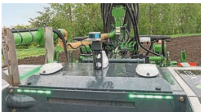
Τα ηλεκτρικά μοτέρ κινούν τις ερπύστριες με ταχύτητα πορείας από 0,1 έως 13 x.a.ώ. Το μηχάνημα ζυγίζει περίπου 7 τόνους.
