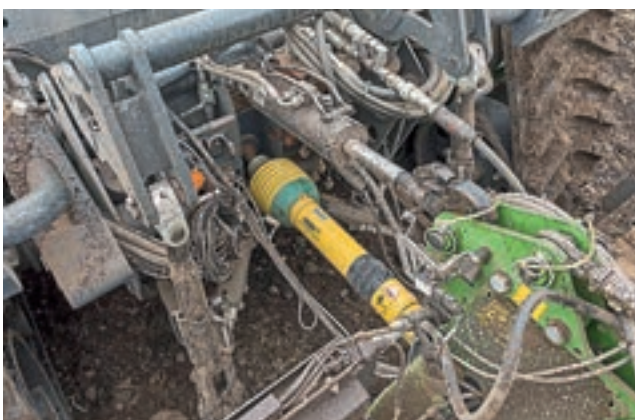
Το AgBot διαθέτει σύνδεσμο τριών σημείων, ρτο και υδραυλικό σύστημα.
