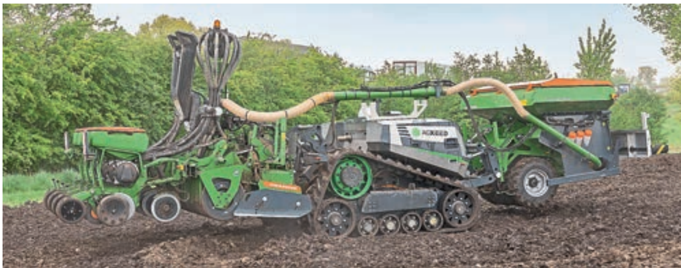
Οι διπλές ερπύστριες παρέχουν στο AgBot μικρό κύκλο στροφής, ενώ ο κατάλληλος σχεδιασμός προσφέρει ακόμη καλύτερη λειτουργία.
