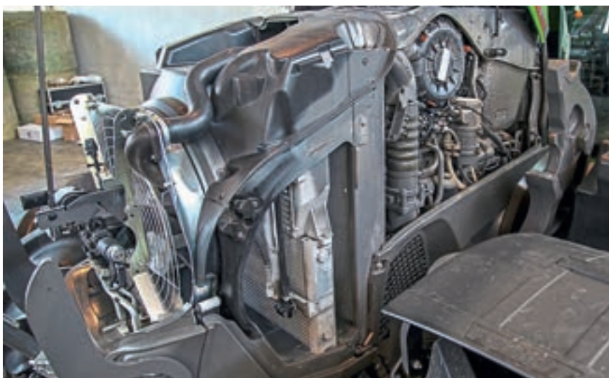
Ο νέος κινητήρας 7,5 λίτρων της AgcoPower φτάνει ήδη την ονομαστική του ταχύτητα σε 1.700 σ.α.λ. Ο καινοτόμος ανεμιστήρας σπρώχνει τον αέρα μέσα από τα ψυγεία.
