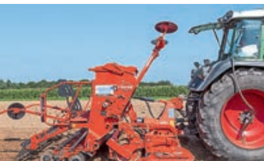
Το «all-round»: Integra 3003 με διπλούς δίσκους σε δισκοσβάρνα HRB303.
