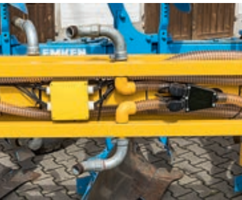
Οι βαλβίδες ανοίγουν τους κάτω σωλήνες σποράς για να ταιριάζουν με την πλευρά του άροτρου.
