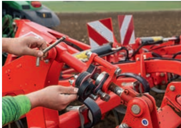
Για την αλλαγή του βάθους εργασίας, τα απαιτούμενα σφηνοειδή κλιπ κινούνται προς τα έξω και στερεώνονται στη θέση τους με έναν πύρο.
