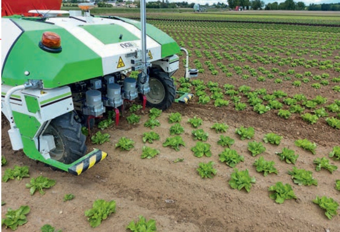
Επίσης νέα στο αναβαθμιζόμενο ρομπότ είναι αυτά τα μαχαίρια καλλιεργητή και το σύστημα κάμερας
