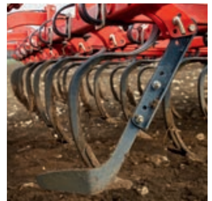
Τα δόντια κάλυψης παρέχουν ικανοποιητικό αποτέλεσμα ισοπέδωσης. Τα δόντια σε σχήμα Y προσφέρονται για χρήση σε πλήρες πλάτος.
