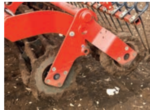
Επειδή οι διπλοί κύλινδροι περιστρέφονται, το φορτίο χωρίζεται ομοιόμορφα μεταξύ τους.
