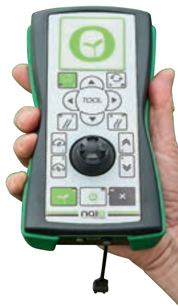
Αυτό το joystick επιτρέπει στον χρήστη να κατευθύνει και να χειρίζεται το Dino από απόσταση, ώστε να μπορεί να τοποθετηθεί σε σειρές και να εργαστεί.
