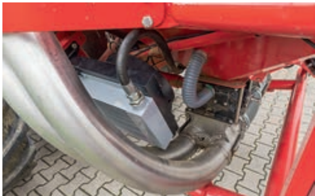
Ένα ζεύγος σωλήνων σπόρων παίρνει τον σπόρο στους διανομείς στο κεφάλι του άροτρου. Ο πρόσθετος ανεμιστήρας διατηρεί το λάδι δροσερό.
