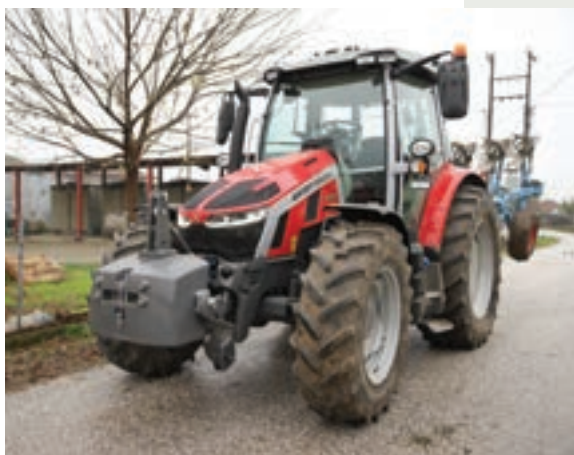
Το τρακτέρ αποδίδει 125 άλογα, καθαρή ιπποδύναμη του κινητήρα των 4.400 κυβικών.
