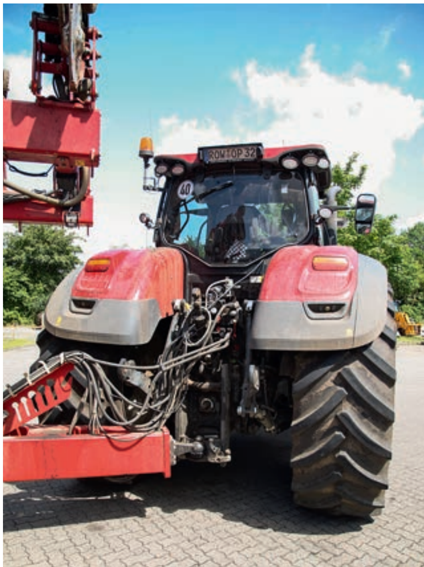
Η ανυψωτική ισχύς και η υδραυλική ισχύς στο πίσω μέρος σημειώνουν άριστα. Δυστυχώς, ορισμένες συνδέσεις λαδιού και υδραυλικές γραμμές άρχισαν να διαρρέουν αλλά λύθηκαν όλα εντός εγγύησης.
