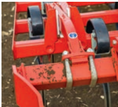
Οι βραχίονες υποστήριξης του κυλίνδρου είναι περασμένοι σε στηρίγματα με επένδυση.
