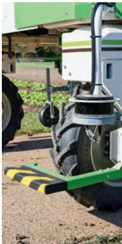
Οι σαρωτές 2D LIDAR και τα ευαίσθητα στην πίεση στοιχεία παρακολουθούν την περίμετρο του μηχανήματος, σταματώντας το αμέσως μόλις ανιχνεύσουν ένα εμπόδιο.
