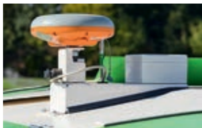
Ο νέος δέκτης δουλεύει με δίκτυα δορυφόρων GPS, Galileo και GLONASS.
