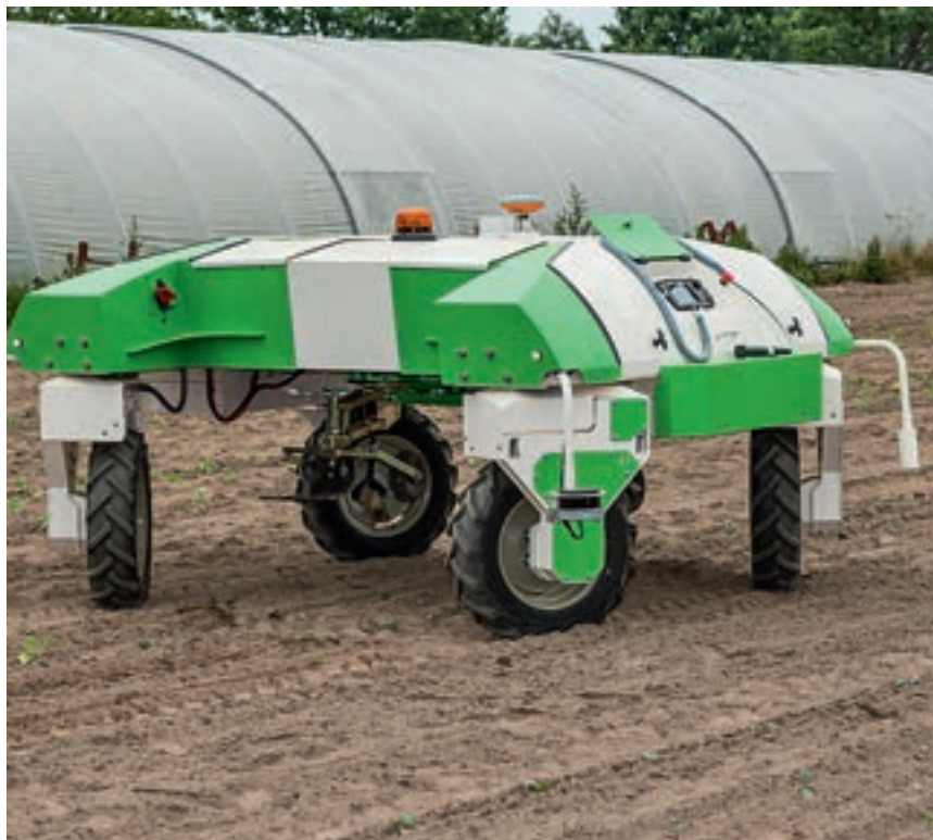
Όλοι οι τροχοί κινούνται και στρίβουν κατά 60°, έτσι το Dino στρίβει επί τόπου. Οι τρέχουσες εκδόσεις δεν χρειάζονται τα πράσινα πλαϊνά δοχεία με επιπλέον μπαταρία.
