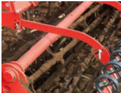
Το πλάτος εργασίας και η γωνία της πίσω σβάρνας μπορεί να ρυθμιστούν χωριστά από την κύρια.
